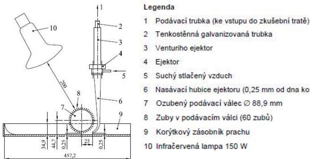
Obr. 54: Korýtkový podavač prachu [18]
