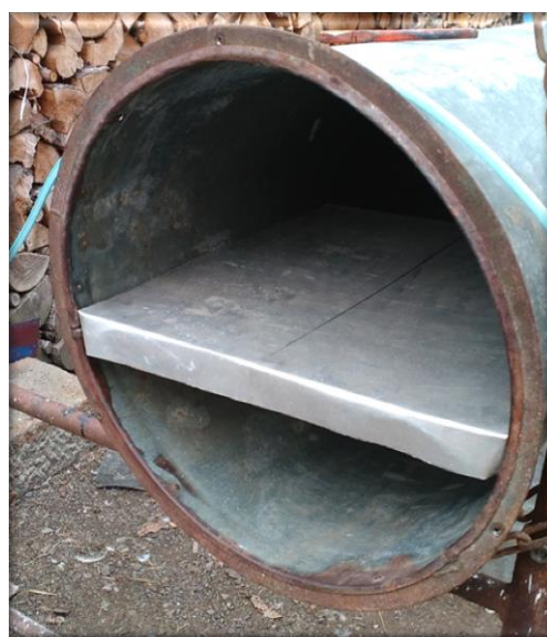
Obr. 72: Umístěný redukční plech
