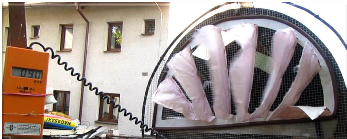
Obr. 128: Filtrační vložka F7 bez použití turbulátoru při rychlosti 9 m/s
