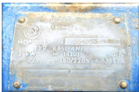
Obr. 43 : Štítek elektromotoru ČKD
