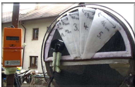
Obr. 97: Filtr G2 a G3 – zkouška šířky lamel (0 m/s)
