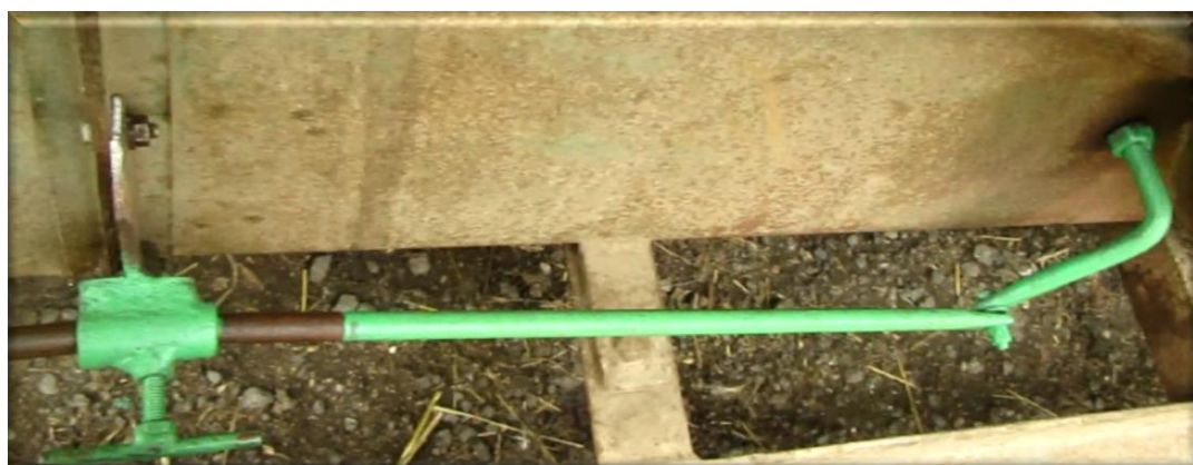
Obr. 53: Pákové táhlo s aretačním šroubem
