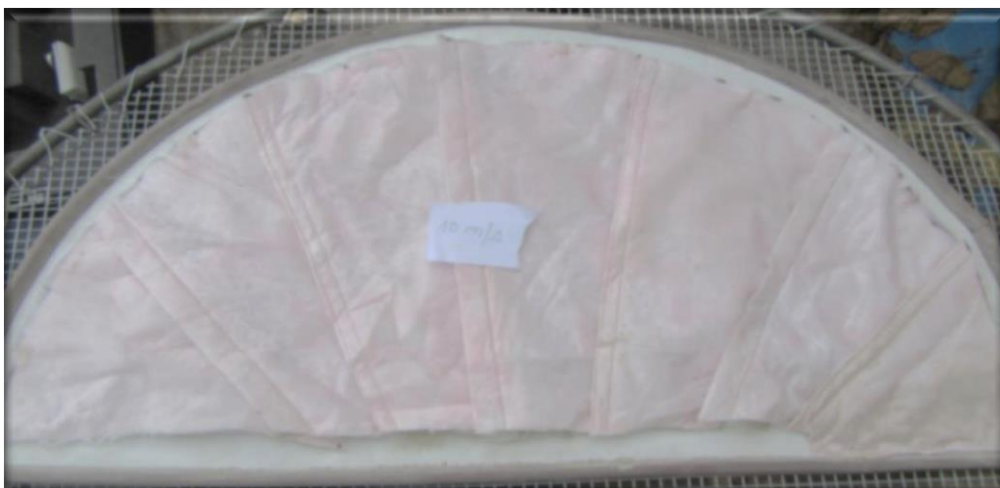
Obr. 132: Filtrační vložka F7 po regenerační fázi při rychlosti 10 m/s
