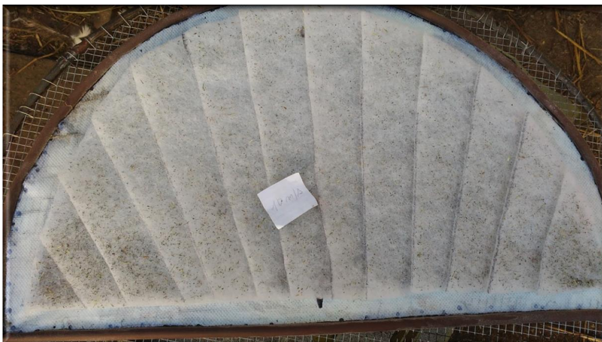
Obr. 125: Zanesení filtrační vložky G2 po regeneraci při rychlosti 10 m/s
