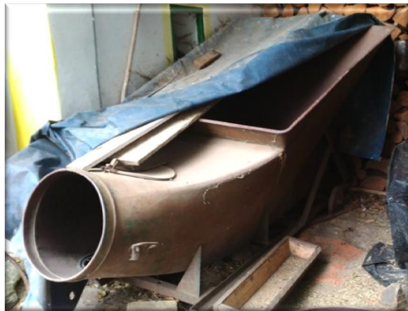
Obr. 32: Fukar sena s radiálním ventilátorem
