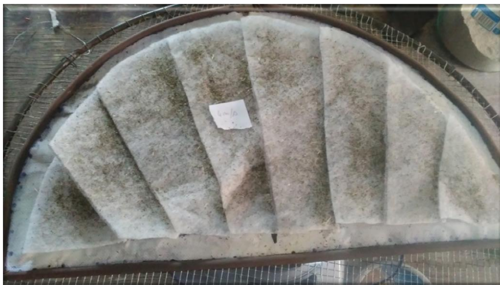
Obr. 118: Zanesení filtrační vložky G2 po regeneraci při rychlosti 4 m/s
