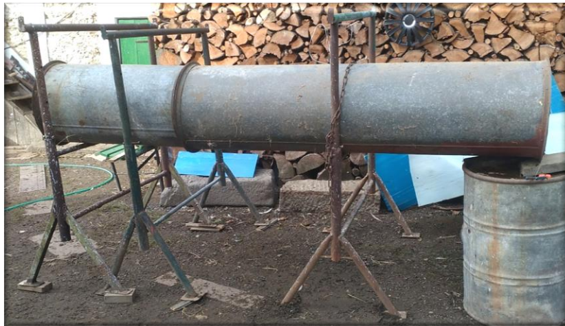
Obr. 63: Zinkované potrubí o průměru 500 mm
