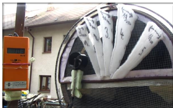
Obr. 98: Filtr G2 a G3 – zkouška šířky lamel (10 m/s)
