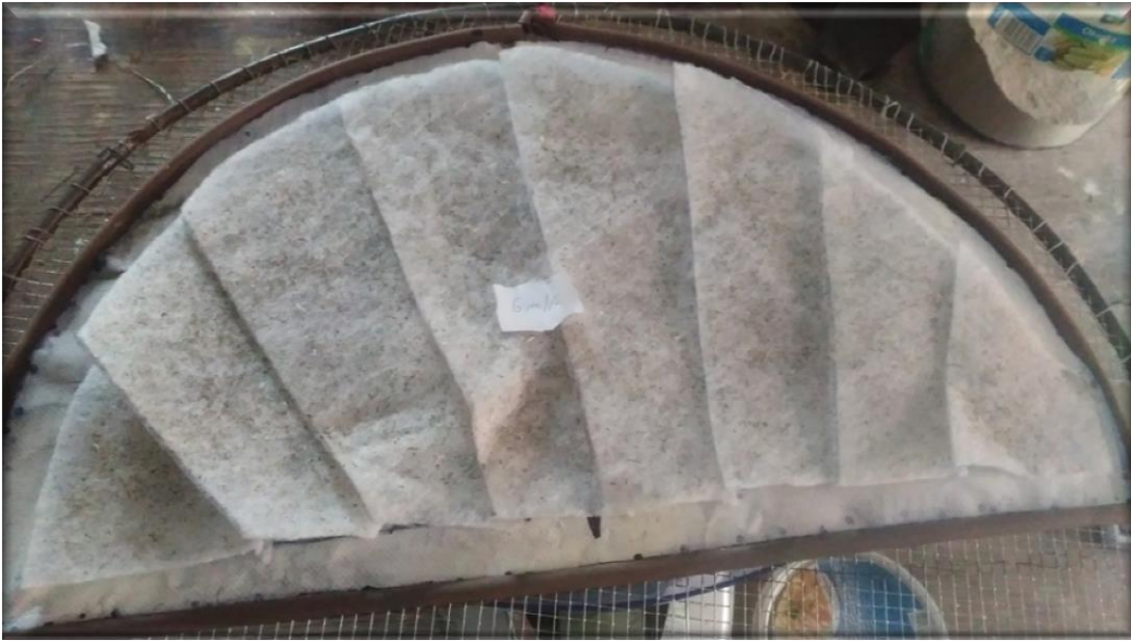
Obr. 119: Zanesení filtrační vložky G2 po regeneraci při rychlosti 6 m/s
