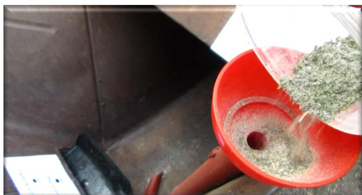
Obr. 56: Plnění podavače prachovými částicemi
