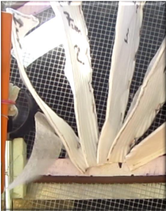
Obr. 108: Rozpad souvrství lamely a odtržení od podkladu
