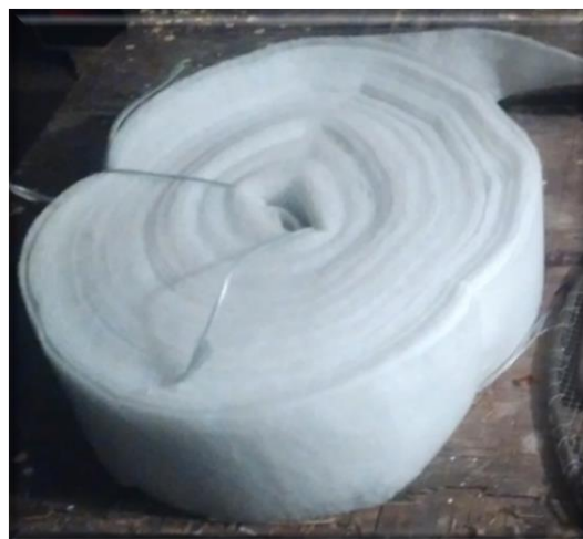
Obr. 96: Filtrační materiál – polypropylen 100%, tl. 5 mm
