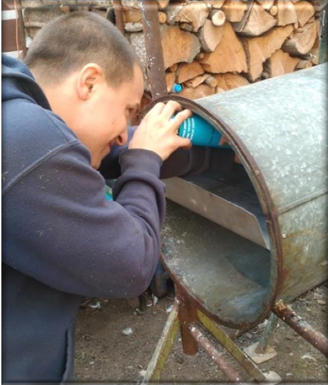
Obr. 77: Aplikace těsnící housenky
