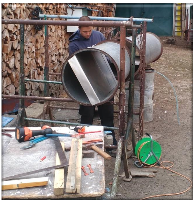
Obr. 71: Fixace redukčního plechu
