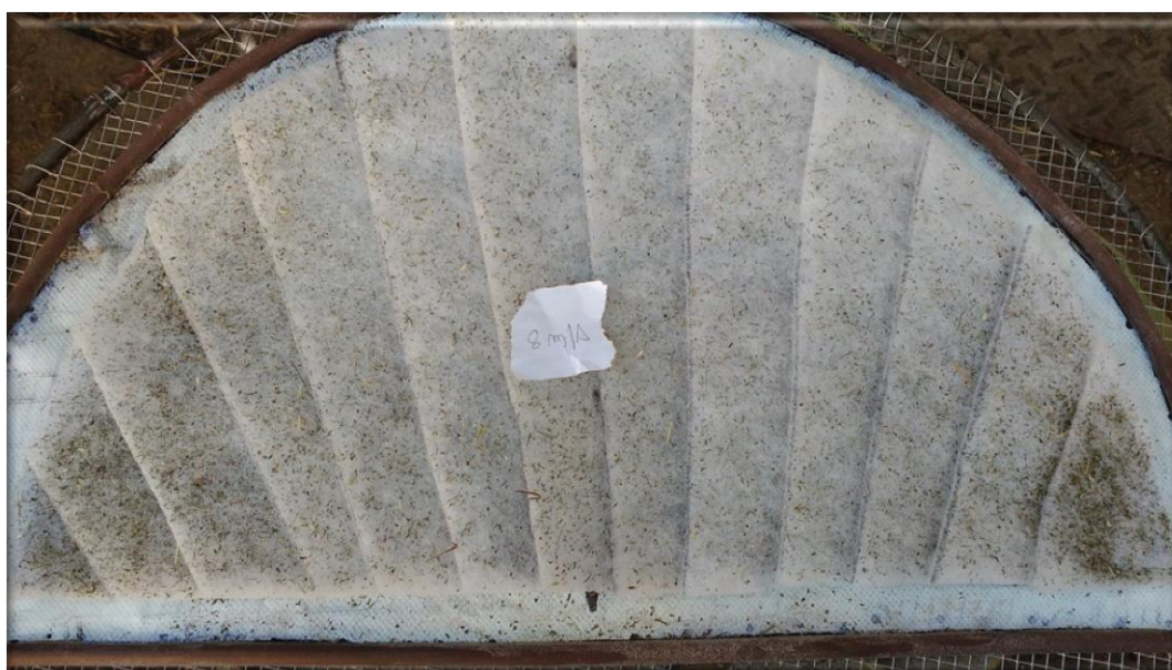
Obr. 126: Zanesení filtrační vložky G2 po regeneraci při rychlosti 8 m/s
