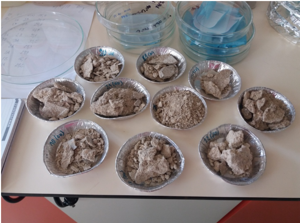
Obr. 46: Odebrané vzorky pro gravimetrické zjištění obsahu vlhkosti
