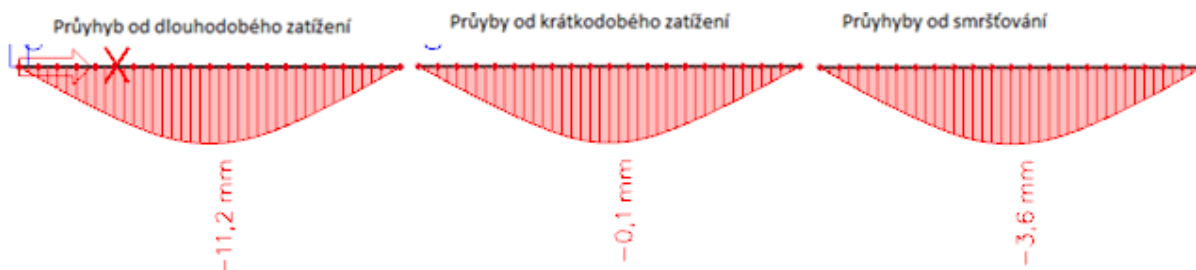
Obr. 33 Výsledky metody s respektováním proměnné tuhosti po délce nosníku
