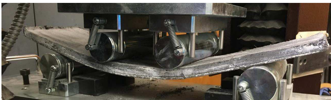
Obrázek 26: Zkouška destiček čtyř-bodovým ohybem
