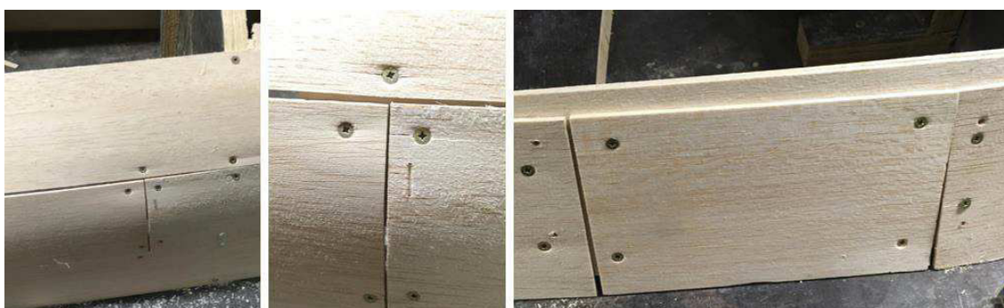
Obrázek 50: Stykování balsy (vlevo, uprostřed) stykování u zádi (vpravo)
