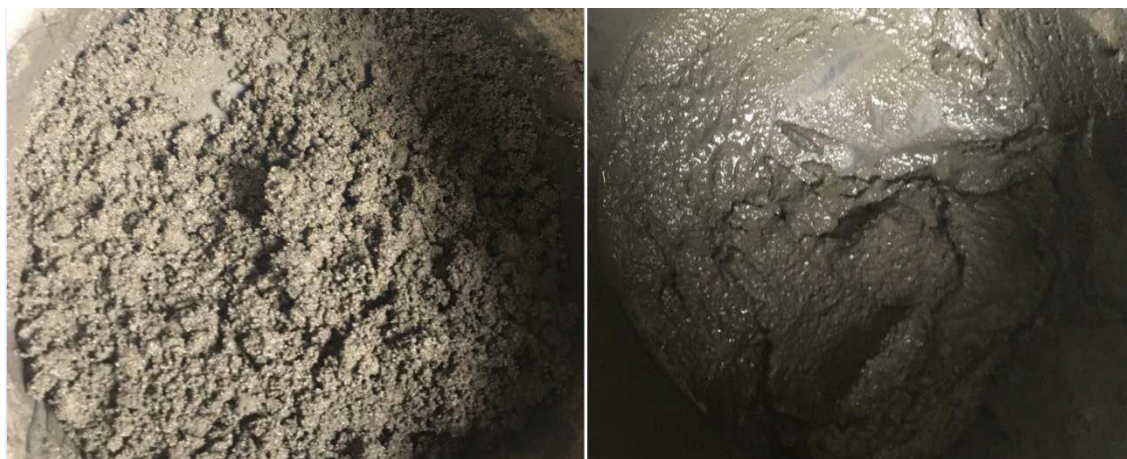
Obrázek 18: Změna konzistence směsi po přidání superplastifikační přísady
