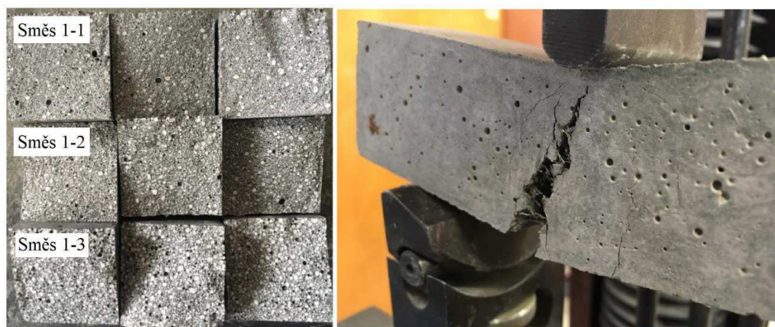
Obrázek 25: Trámečky po zlomení (vlevo), trámeček při zkoušce (vpravo)
