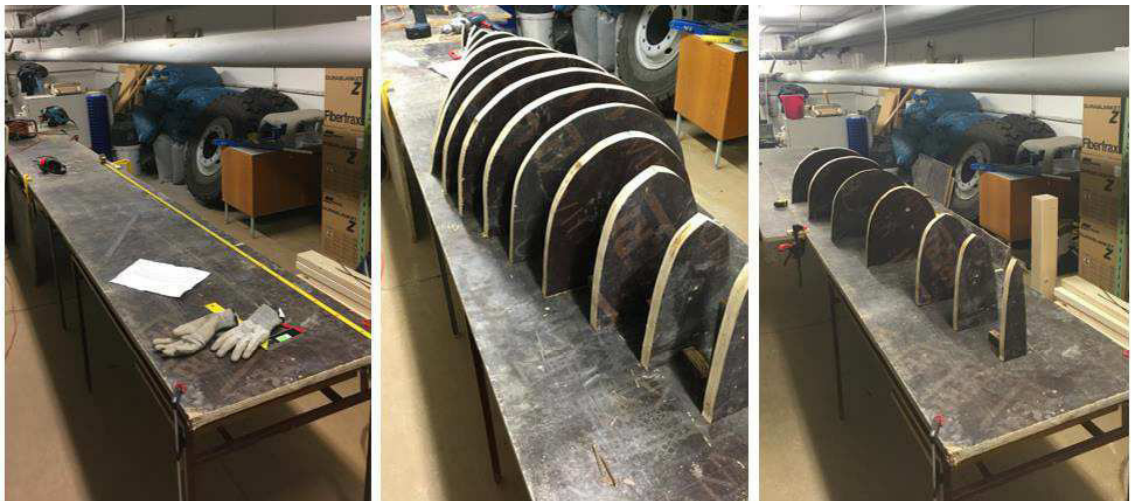
Obrázek 48: Pracovní rovina (vlevo), kompletní sestava profilů (uprostřed), postup prací (vpravo)
