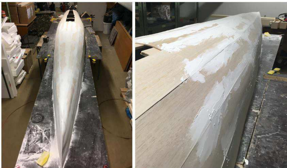
Obrázek 51: Tvorba kopyta: kapotování, tmelení a broušení
