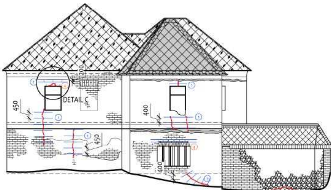
Obrázek 46 – jihozápadní pohled s vyznačením svázání trhlin
