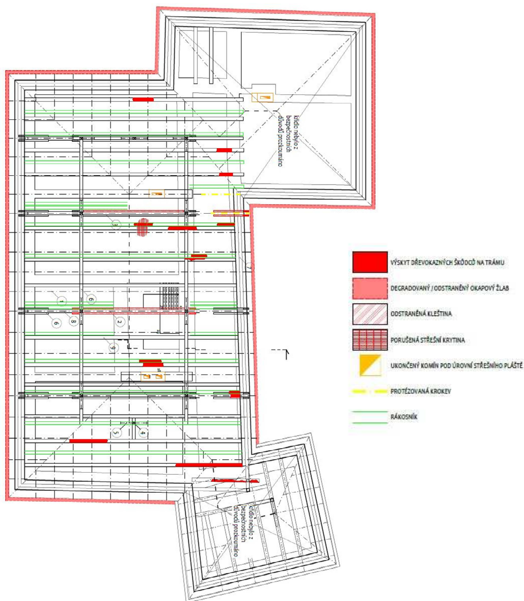
Obrázek 33 – schéma poruch v podkrovní části objektu
