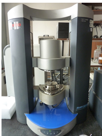
(A) Rheometer HAASE MARS
