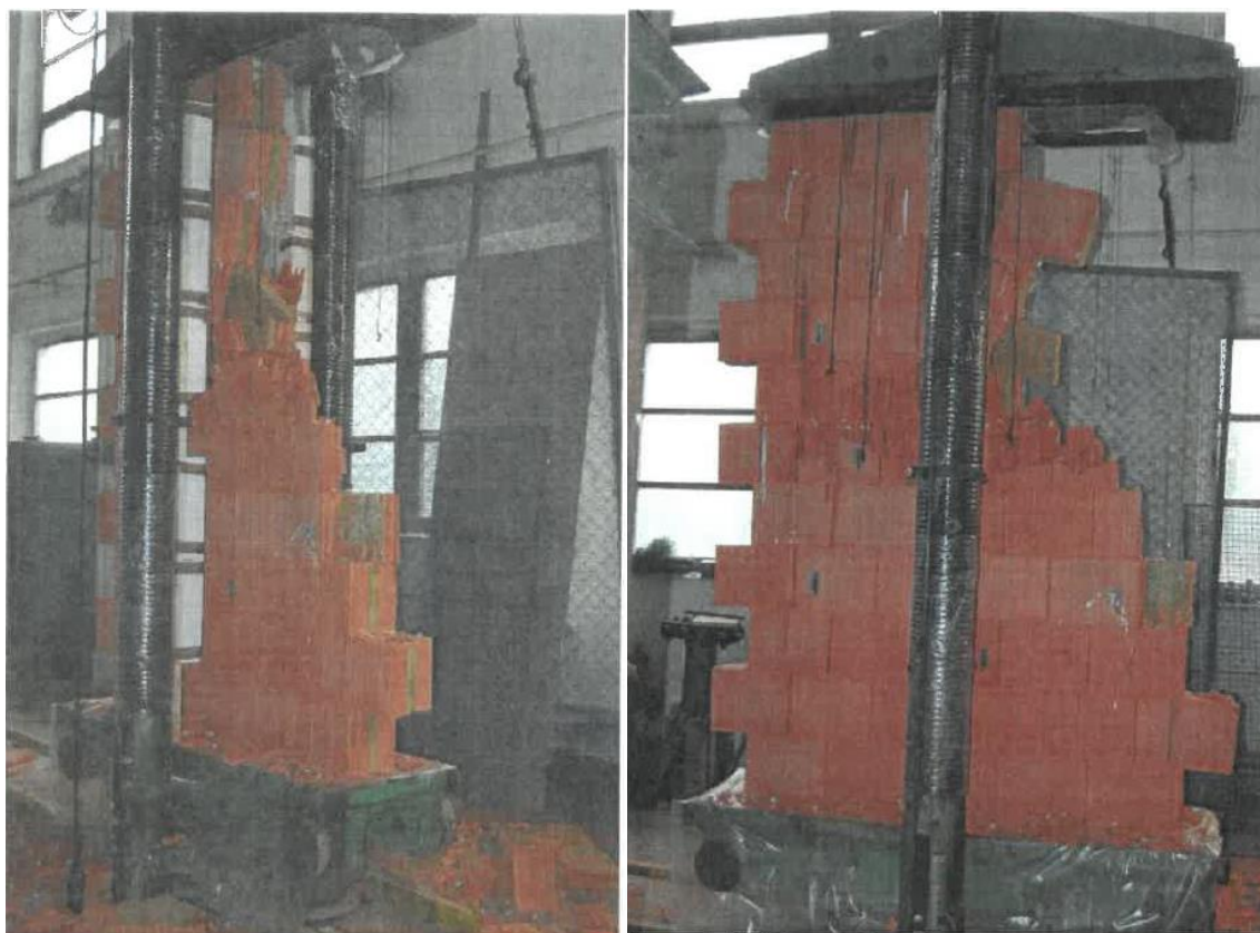
Obr. 6.17: Porušení vzorku VS1 po zkoušce
