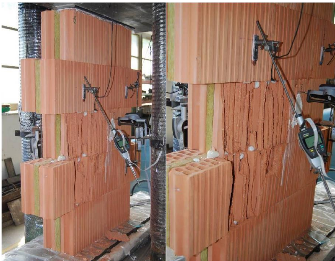
Obr. 6.10: Porušení vzorku 5 EN po konci zkoušky
