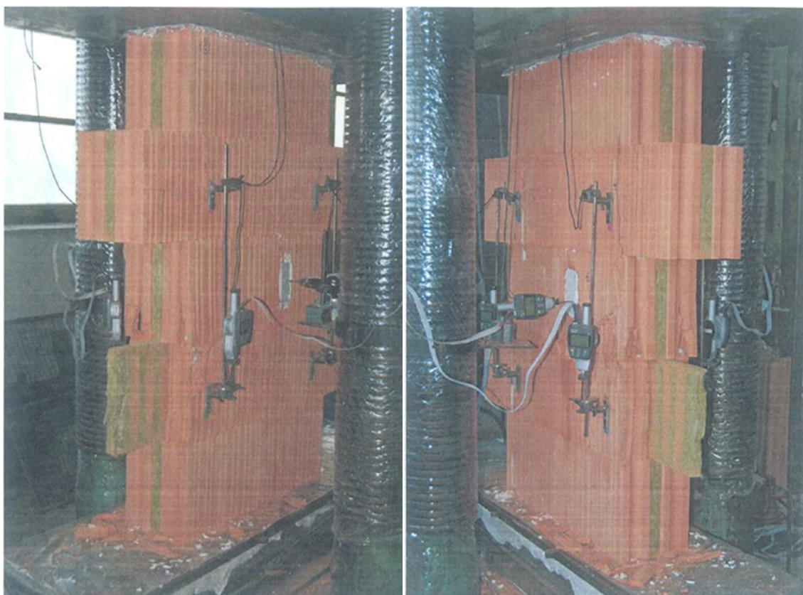
Obr. 6.6: Porušení vzorku 2 EN po konci zkoušky
