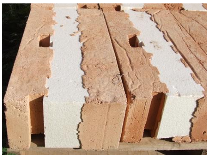
Obr. 3.2: Tvárnice vyrobená z dřevobetonu [8]
