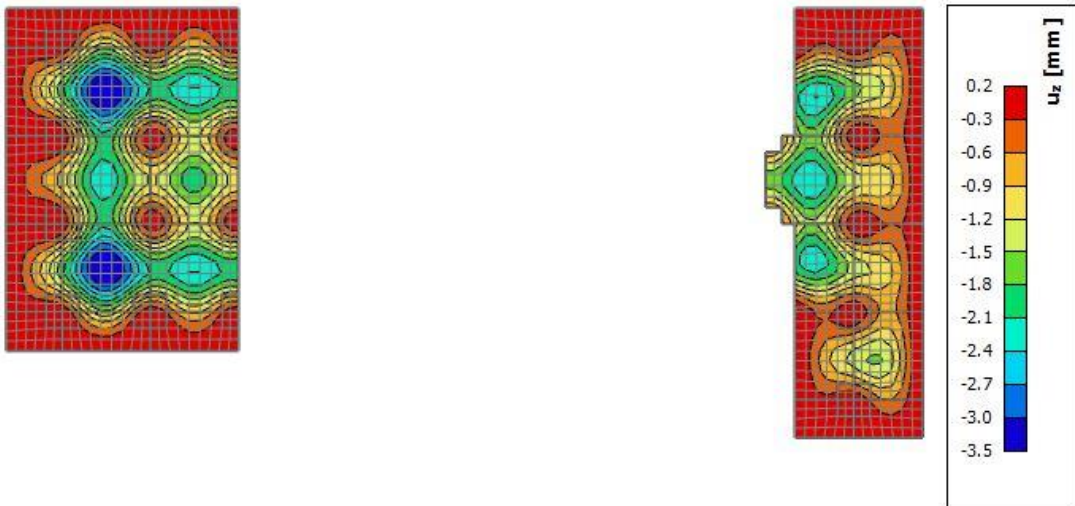
Obr. Výsledné hodnoty w_{el} od účinků kvazistálé kombinace v místě působení užitečného zatížení kategorie C1, pro desku tloušťky 250 mm v poli, zesílenou na tloušťku 400 mm v místě uložení na sloup [mm]
