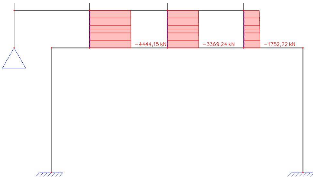
Obr. Model č.1 – Normálová síla N v patě sloupů a stěn (6.10a – 6.10b) [kN]
