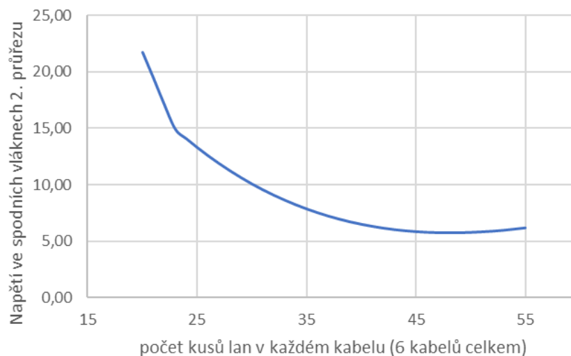
Obr. Graf průběhu tažených napětí ve spodních vláknech 2. průřezu v závislosti na počtu předpínacích lan
