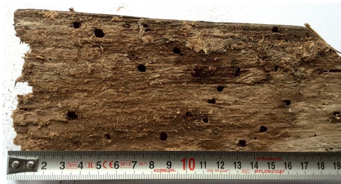
Obrázek 34 – Výletové otvory tesaříka a červotoče
