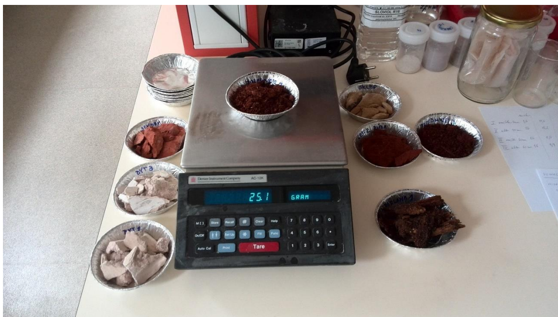
Obrázek 31 – Vážení vzorků před sušením
