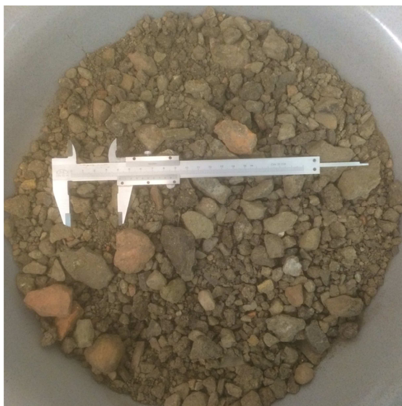
Obr. č. 4: Navážky (vzorek 1) pro stanovení zrnitosti zeminy (zdroj: autor)
