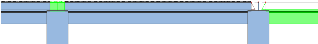
Obr.3.27 – Zrušení dočasných podpor u levého příčnicku a spřažení s ním. Uložení nosníku v dalším poli.
