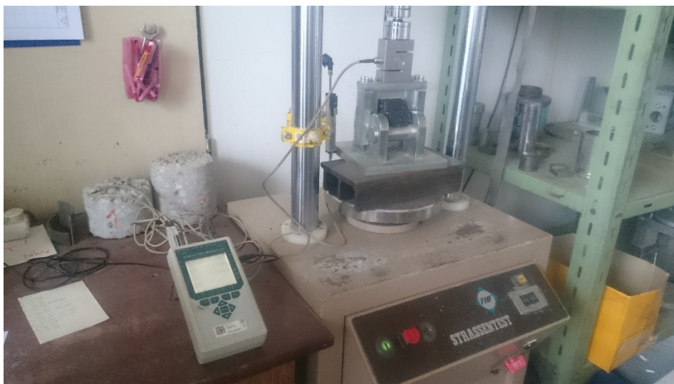
Obrázek 21: Půlválcové těleso v lisu, záznam zkoušky pomocí dataloggeru Almemo
