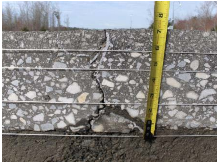
Obrázek 3: Únavová trhлина "bottom-up" [5]
