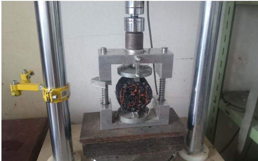
Obrázek 20: Marshallovo těleso v zatěžovacím lisu při zkoušce stanovení pevnosti v příčném tahu
