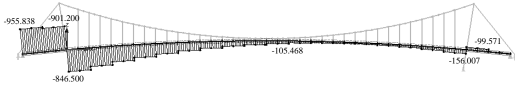
Obr. č.32 – Rozhodující vnitřní síly N_{ed} (kN)
