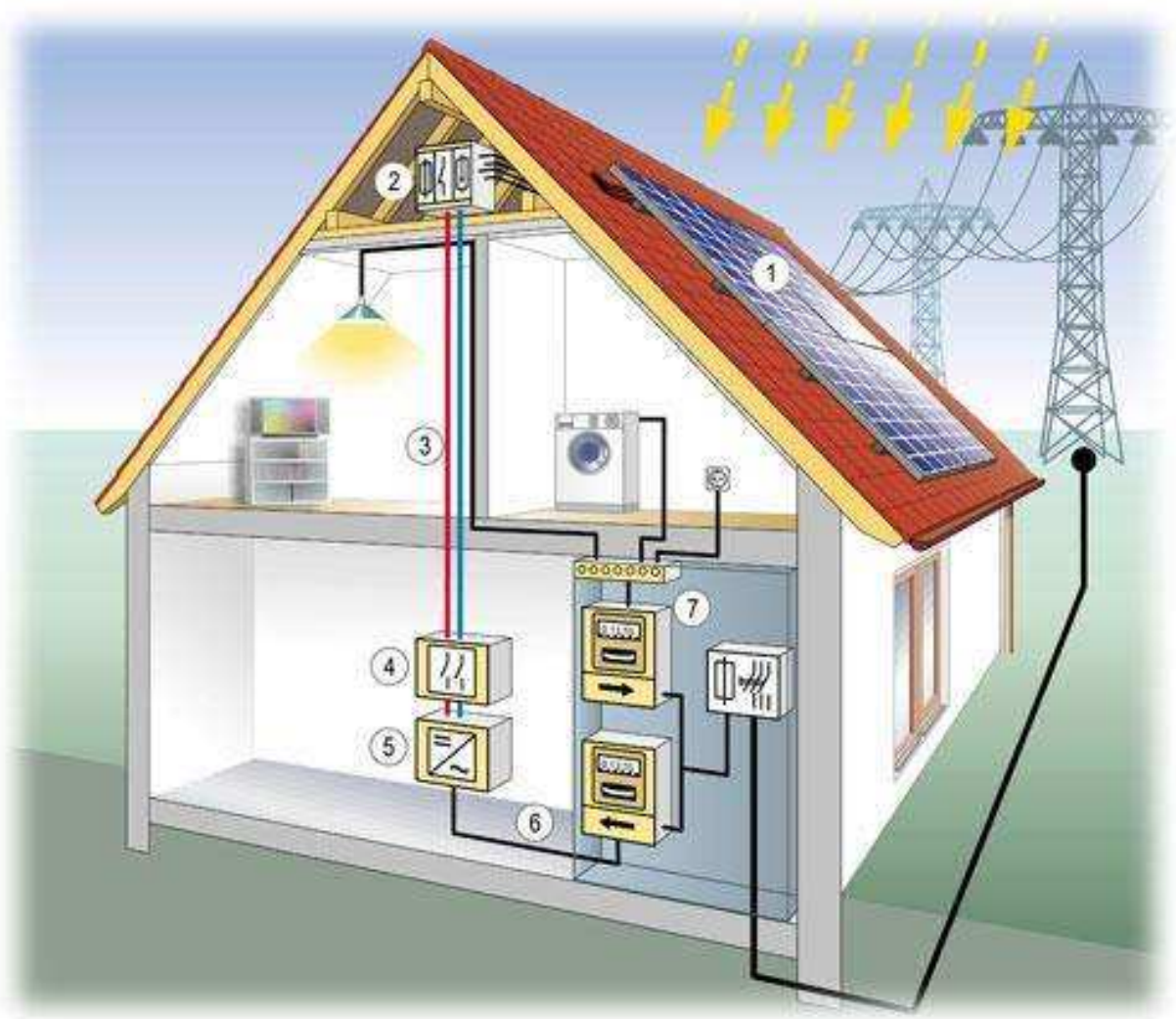
Obrázek 5: Fotovoltaický solární systém [14]
