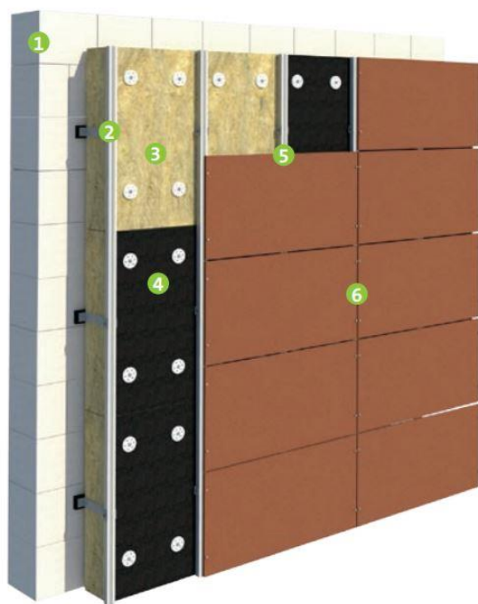
Obrázek 3: Difuzně otevřený zateplovací systém
