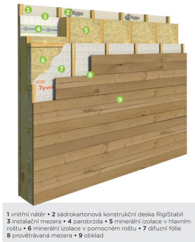
Obrázek 4: Sendvičový systém
