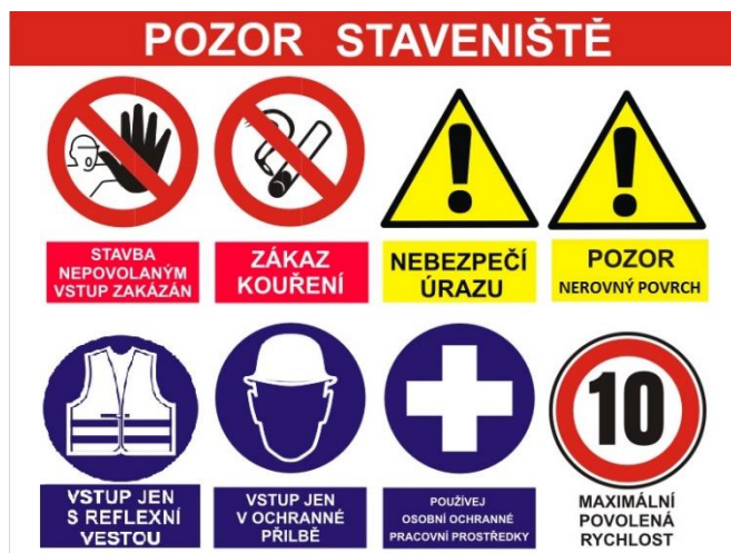
Obr. 44 Značení u vstupu na staveniště
