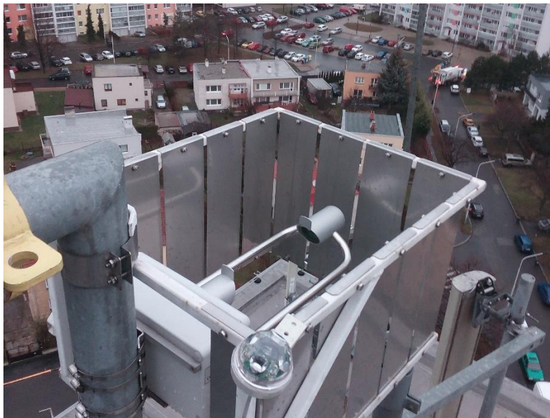
Obr. 8: Laserový detektor srážek umístěný na experimentálním místě, na střeše panelového domu o výšce cca 35 m. Praha Letňany, rok 2015.
