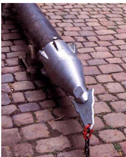
Obr. 9.11: Pneumatické propichovací kladivo [27]
