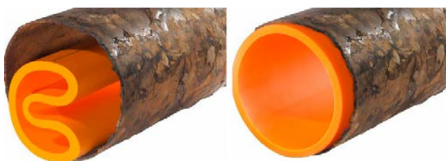
Obr. 9.7: C Profil zatahovaného potrubí [22]
