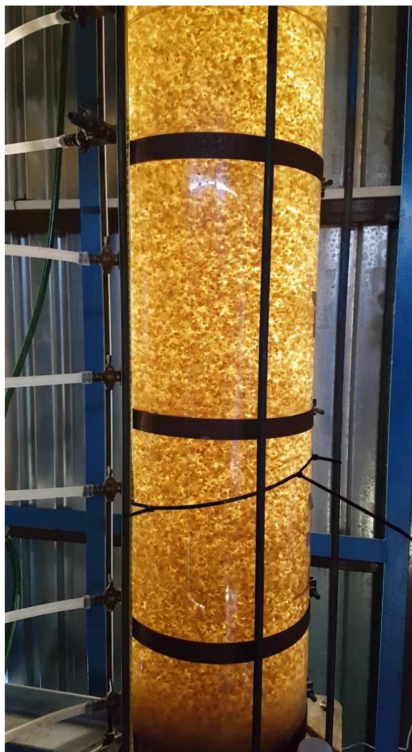
Obr. 9 Detail sedimentačního válce na počátku sedimentace
