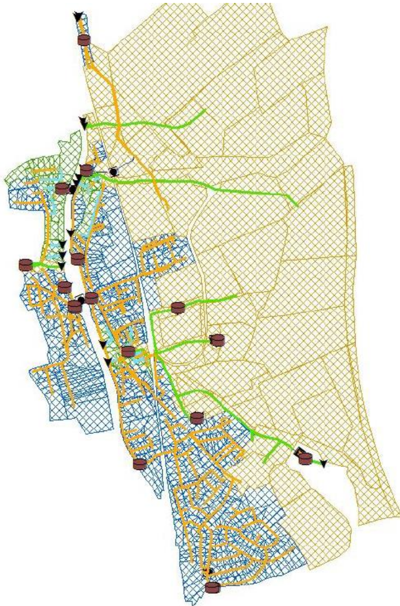
Obr. 18 Povodí kanalizační sítě pro současný stav [37]
