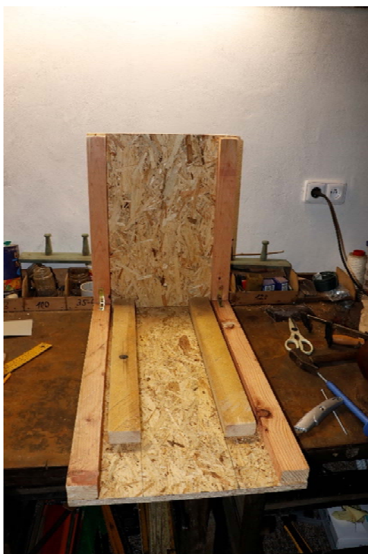
Skladba č. 3: Vytvoření mezery 161 mm latěmi 30x60 mm jako simulace mezery trapézového plechu TR 150/280
