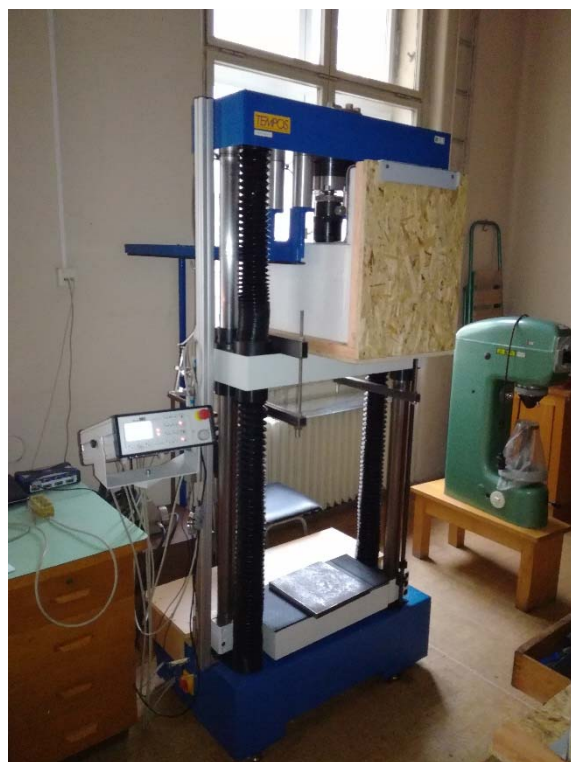
Zatěžovací stroj s umístěnou plochou deskou z oceli o rozměru 100x300 mm napodobující lidskou botu při cyklickém zatěžování
