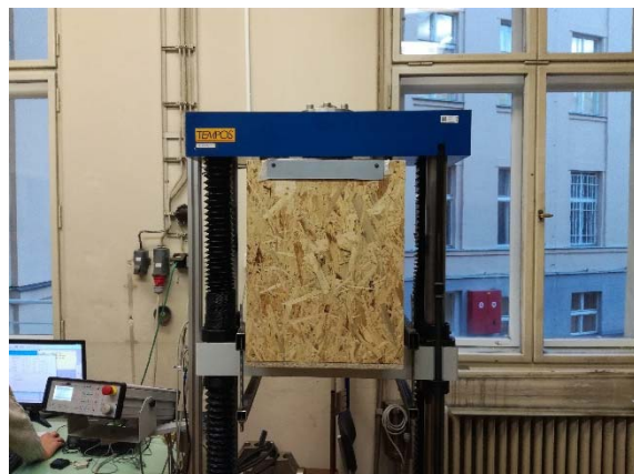
Zatěžovací stroj s umístěným modelem před cyklickým zatěžováním
