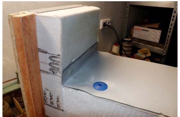
Skladba č. 1: Přikotvení tepelné izolace EPS 100 a PVC-P fólie kotvou do nosné konstrukce
