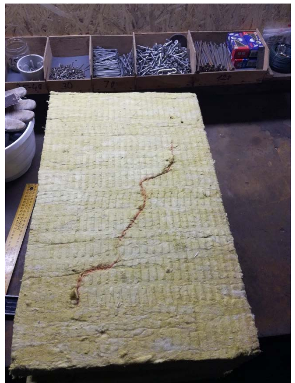
Skladba č. 3: Pohled zespodu na spodní desku, deska vykazuje vadu ve formě šikmé trhliny
