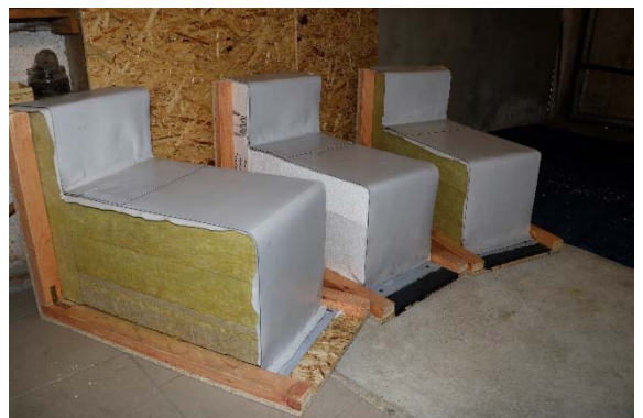
Všechny tři modely, zleva: Model s MW Monrock MAX E s latěmi simulující trapézový plech TR 150/280, model s EPS 100, model s MW Monrock MAX E
