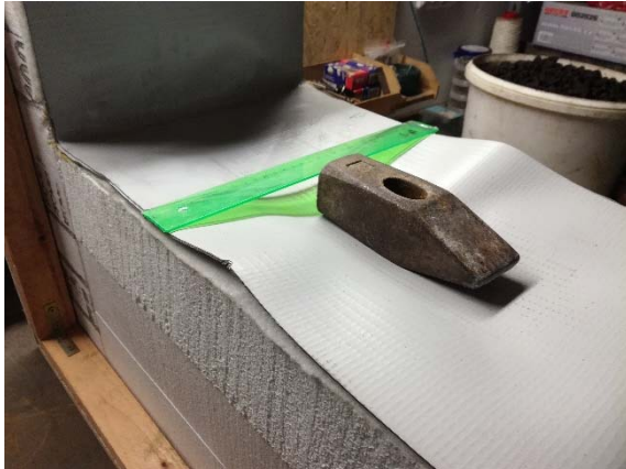
Skladba č. 1: Na první pohled viditelné poškození horní vrstvy EPS 100
