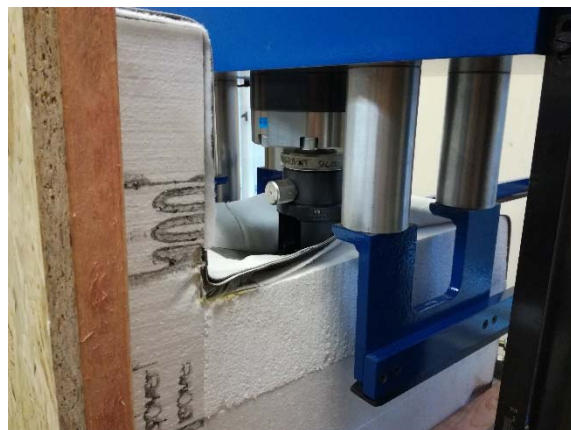
Skladba č. 1: Konečný stav stlačování u zkoušky o maximálním zatěžování
