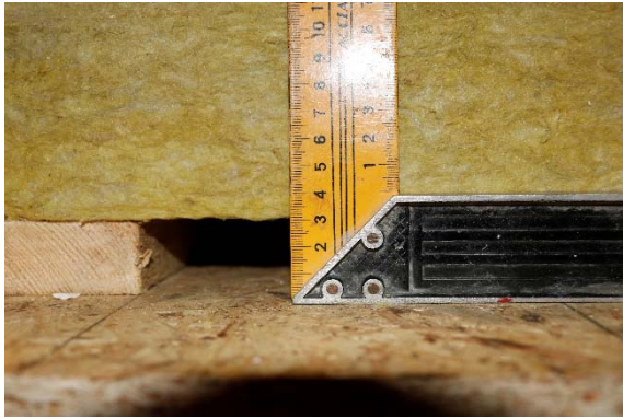
Skladba č. 3: Mezera 30 mm, simulace mezery trapézového plechu TR 150/280
