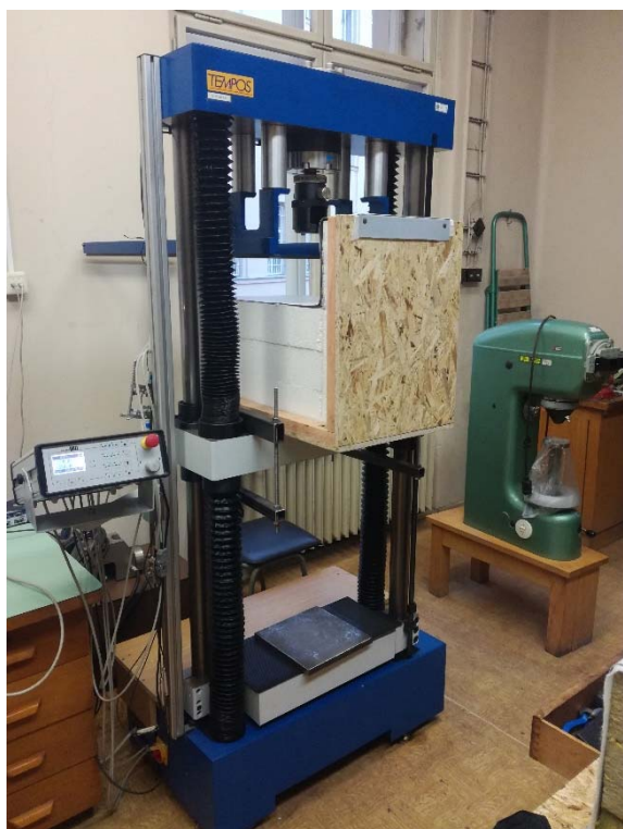
Zatěžovací stroj s umístěným modelem před cyklickým zatěžováním
