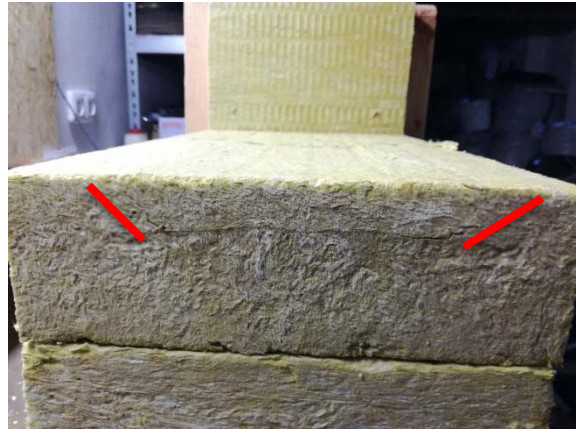
Skladba č. 2: Čelní pohled, vznik šikmých trhlin (označeny červeně)
