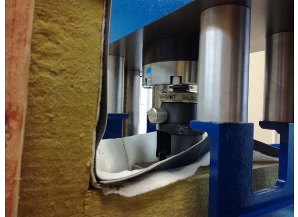
Skladba č. 3: Konečný stav stlačování u zkoušky o maximálním zatěžování
