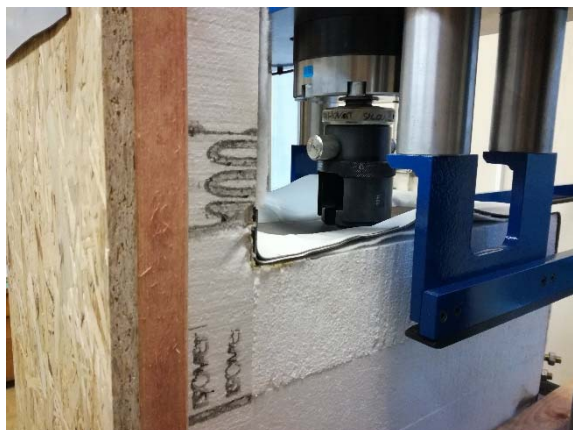
Skladba č. 1: Začátek zkoušky o maximálním zatěžování
