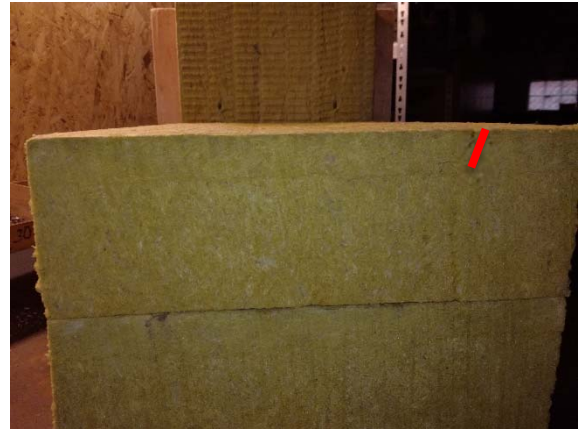
Skladba č. 3: Čelní pohled, vznik šikmých trhlin (označeny červeně)
