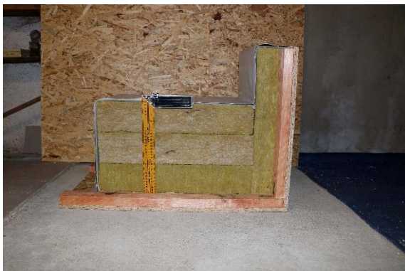
Skladba č. 3: Model s MW Monrock MAX E tl. 300 mm, s latěmi simulující trapézový plech TR 150/280
