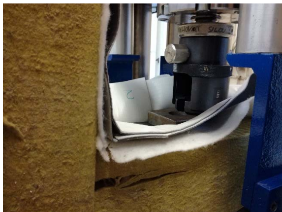
Skladba č. 2: Konečný stav zkoušky o maximálním zatěžování, pohled na trhlinu na pravé straně v horní vrstvě tepelné izolace z MW
