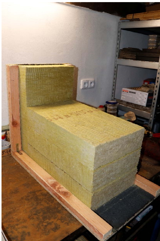
Skladba č. 2: Desky Monrock MAX E 300x500 mm v nosné konstrukci, na které je již nataven pás z SBS modifikovaného asfaltového pásu
