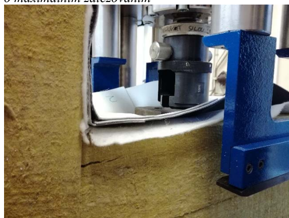
Skladba č. 2: Průběh zkoušky o maximálním zatěžování, vznik trhlin v horní vrstvě tepelné izolace z MW
