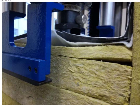
Skladba č. 2: Konečný stav zkoušky o maximálním zatěžování, pohled na trhlinu na levé straně v horní vrstvě tepelné izolace z MW
