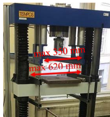
Obr. 13: Rozměrové možnosti zatěžovacího zařízení (zdroj vlastní)
