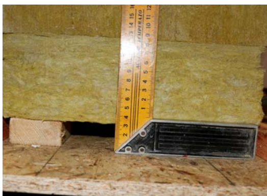
Obr. 11: Skladba č. 3 – mezeru 161 mm jako u vlny TR 150/280 (zdroj autor)
