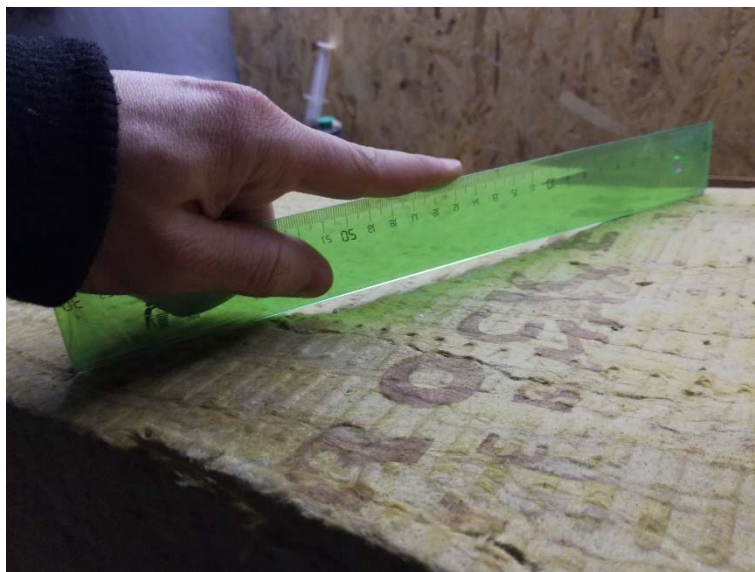
Obr. 20: Měření deformace ve skladbě č. 2 (zdroj autor)
