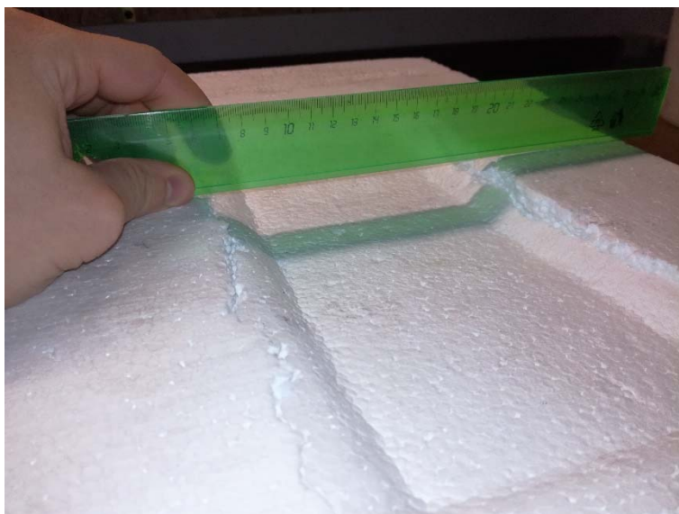
Obr. 19: Měření deformace ve skladbě č. 1 (zdroj autor)
