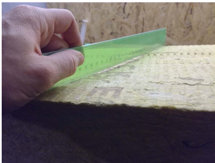
Obr. 21: Měření deformace ve skladbě č. 3 (zdroj autor)
