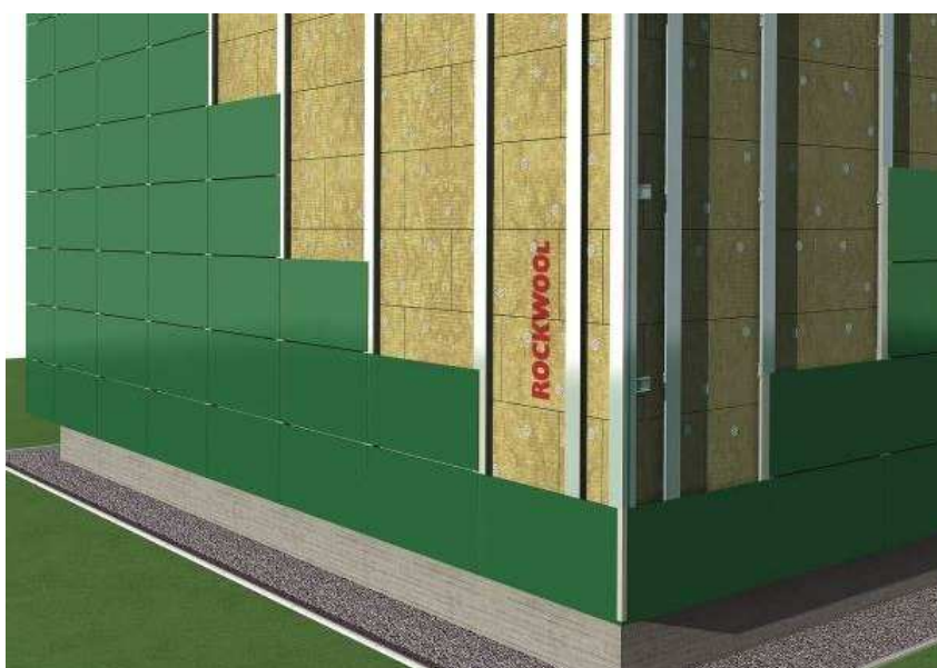
Obrázek 16 Souvrství provětrávané fasády (převzato ze stavba.tzb-info.cz )
