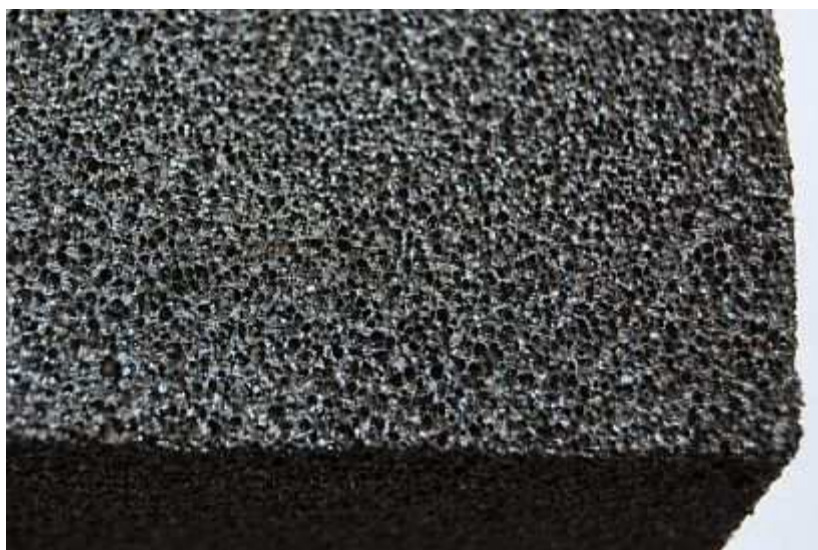
Obrázek 11 Detail struktury pěnového skla (převzato z www.izolace-info.cz )
