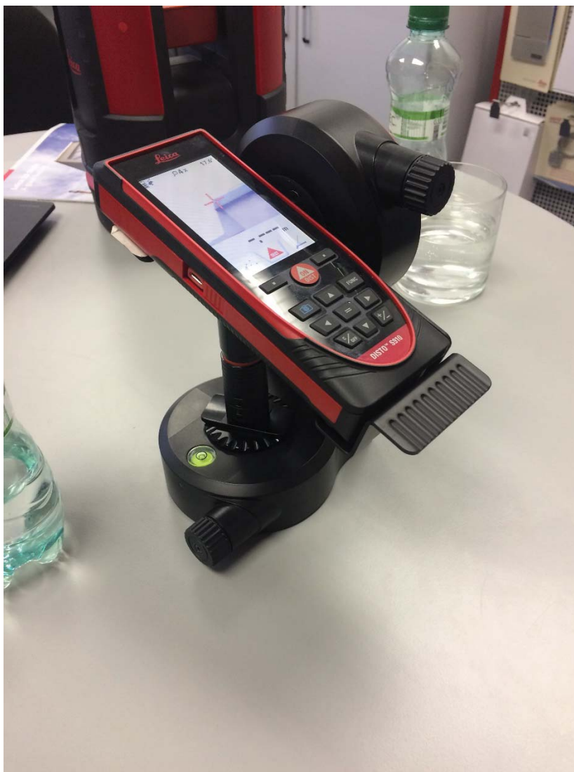
Obr. 39: Laserový dálkoměr Disto S910 a adaptér FTA360-S (Převzato z vlastní galerie obrázků)
