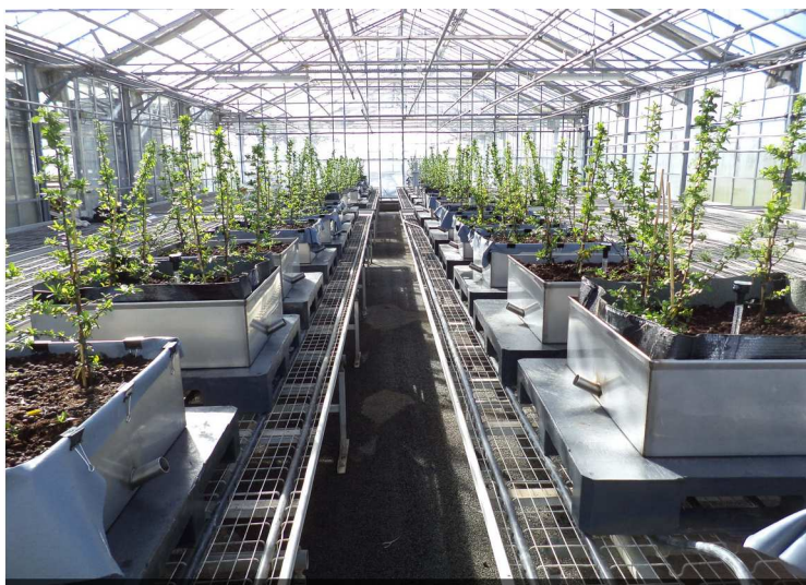
Obrázek 16 - Průběh testu odolnosti proti prorůstání kořenů (zdroj: http://www.critt-horticole.com )
