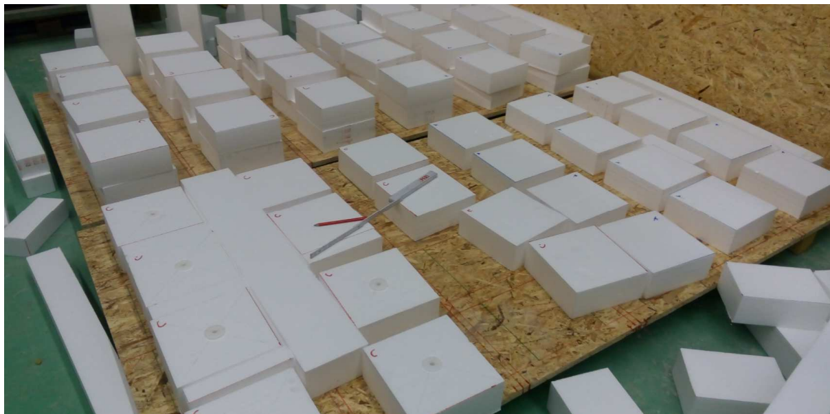
Obrázek 49 - Rozkreslení a rozměření jednotlivých zkušebních vzorků
