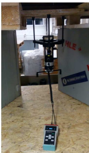
Obrázek 71 - Výtahový stroj připojený na kotevní prvek jako tahoměr
