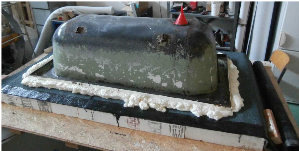
Obrázek 69 - Pokládka a utěsnění zkušební komory
