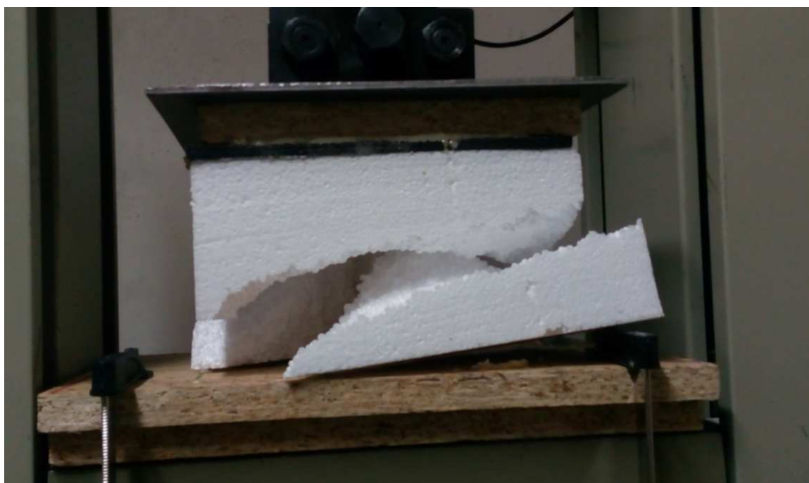
Obrázek 56 - Porušení vzorku při maximální síle
