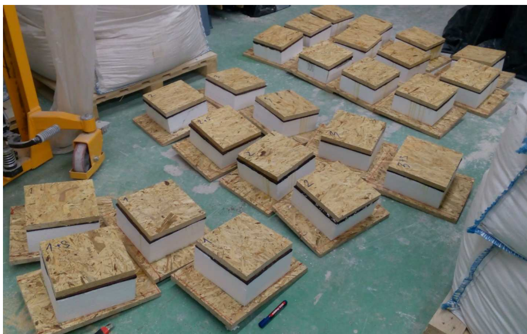
Obrázek 54 - Zkušební tělesa s nalepenou OSB deskou
