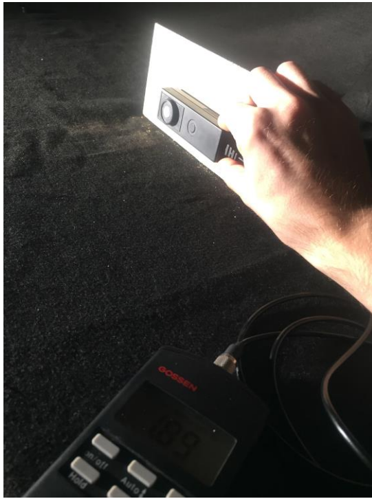
Obr. 26, 27: Měření luxmetrem, zdroj : Auto
