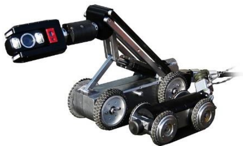
Obr. 32 – Příklad kamery pro kamerový průzkum potrubí
