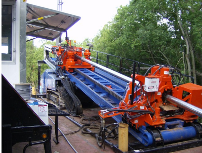
Obr. 26 – Horizontální řízené vrtání [71]
