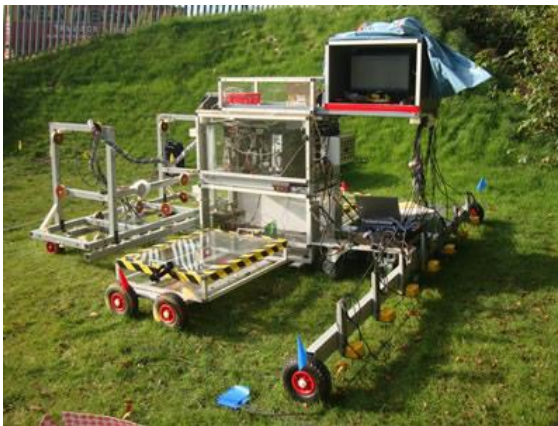
Obr. 31 – Funkční prototyp multisenzorového detekčního zařízení, skládajícího se z elektromagnetických senzorů
