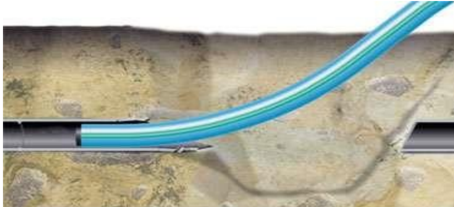
Obr. 19 – Technologie obnovy potrubím prostým vyložkováním potrubí; prostý relining [68]
