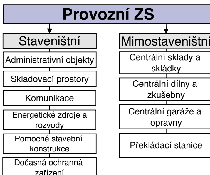
Obr. 2 – Klasifikace provozního zařízení staveniště, příklad [18]
