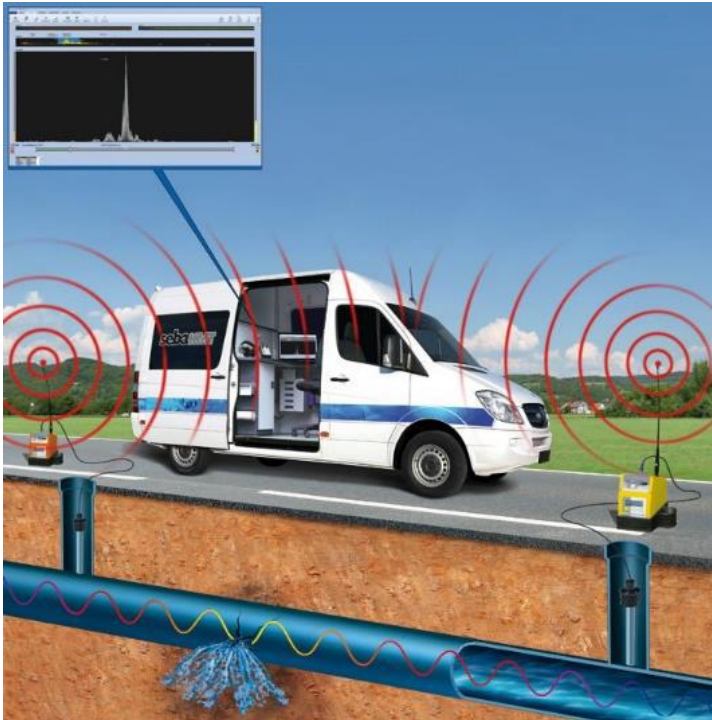
Obr. 33 – Příklad zjišťování míst netěsností tlakových potrubí vodovodů korelátorem
