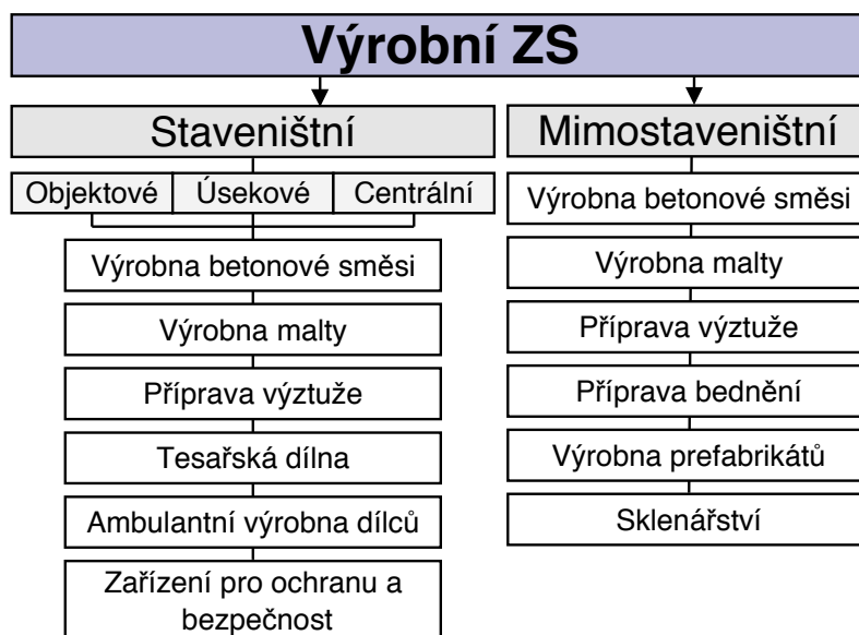
Obr. 6 – Klasifikace výrobního zařízení staveniště, příklad [18]
