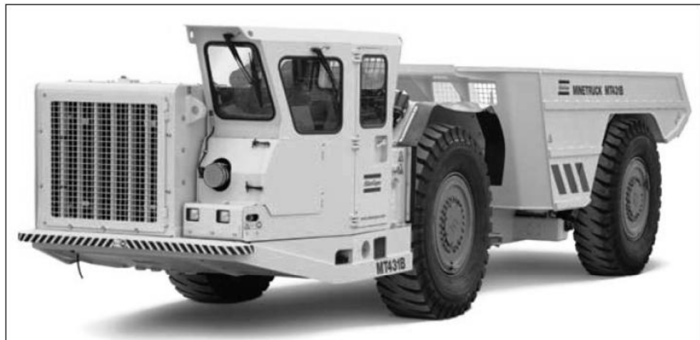
Obr. 8, tuneltruck Atlas Copco MT4312B, zdroj: Podzemní stavby, Pruška, Barták, [2]
