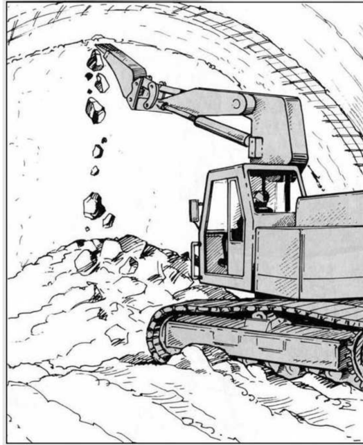
Obr. 5, schéma tunelbagru, zdroj: Podzemní stavby, Pruška, Barták, [2]
