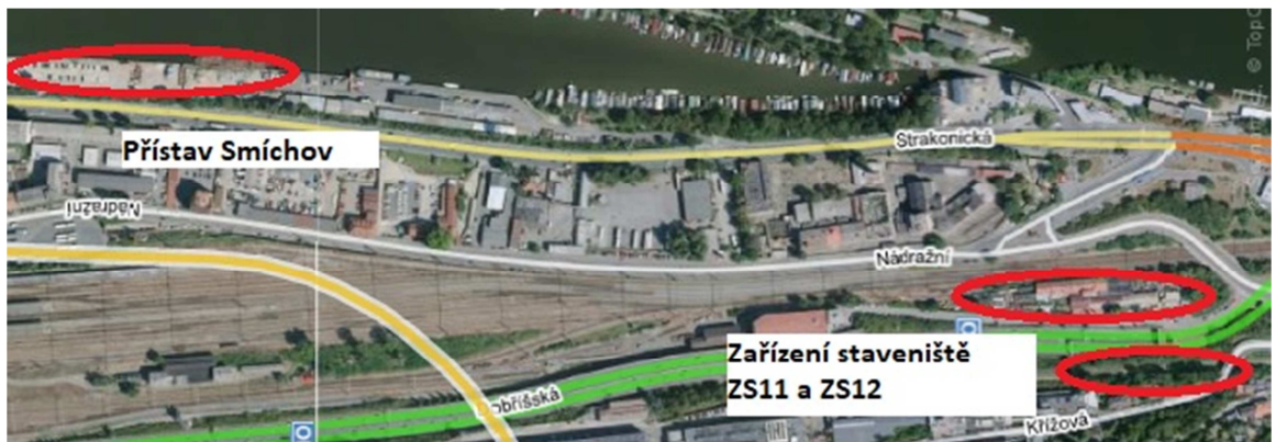
Obr. 49, umístění přístaviště vzhledem k zařízení staveniště
