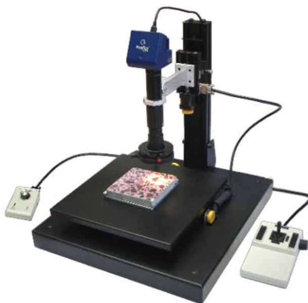
Obrázek 1.6 - Systém pro stanovení charakteristik vzduchových pórů ve ztvrdlém betonu, převzato z [1]
