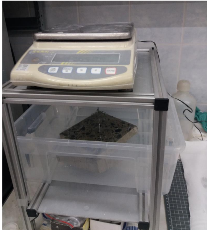
Obrázek 2.9 - Gravimetrická metoda, vážení pod vodou, vlastní tvorba
