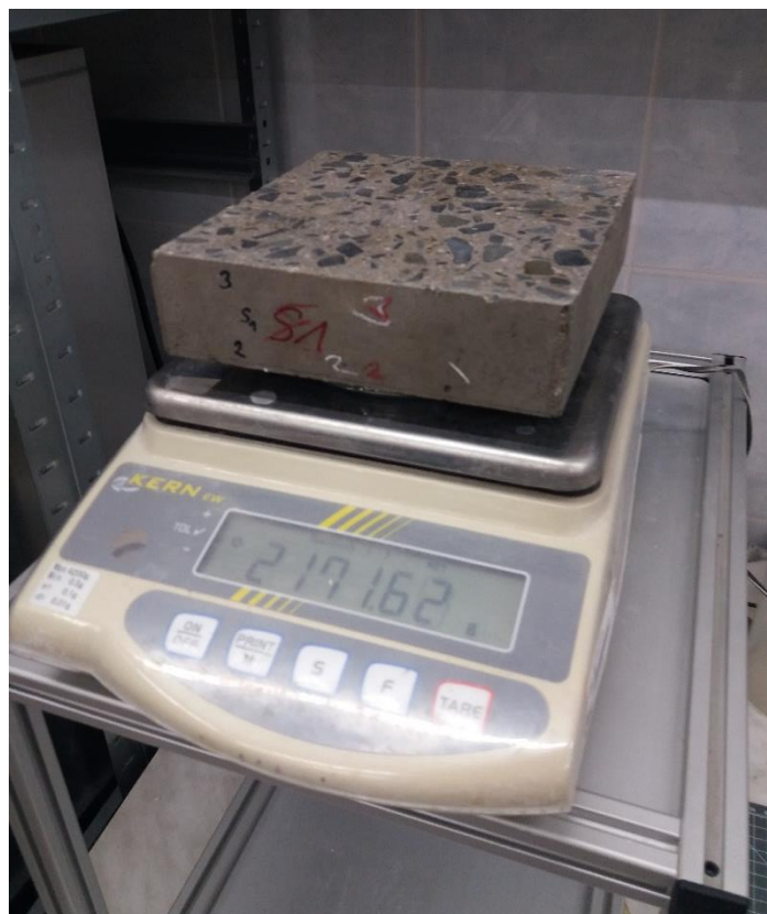
Obrázek 2.10 - Gravimetrická metoda, vážení na vzduchu, vlastní tvorba
