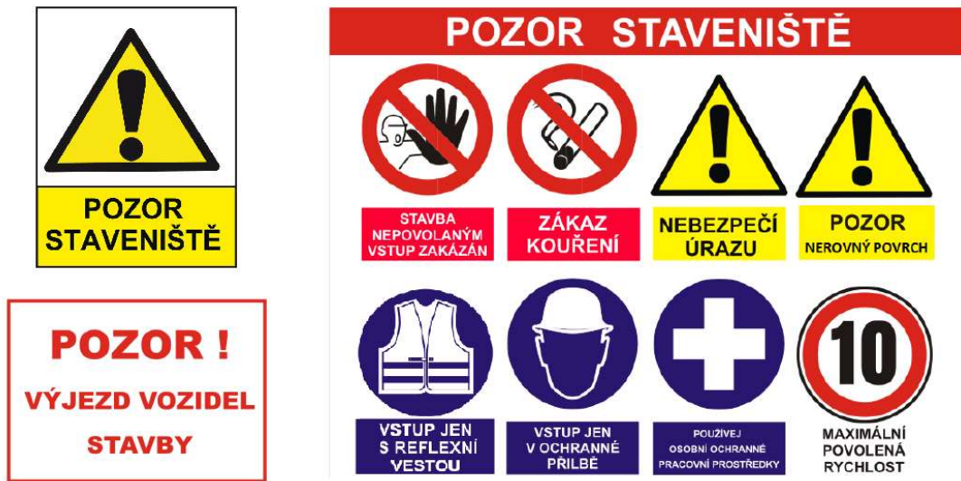
Obrázek 5 - Vzor možné podoby informační tabule ke vstupu do staveniště (Zdroj: převzato z [13])
