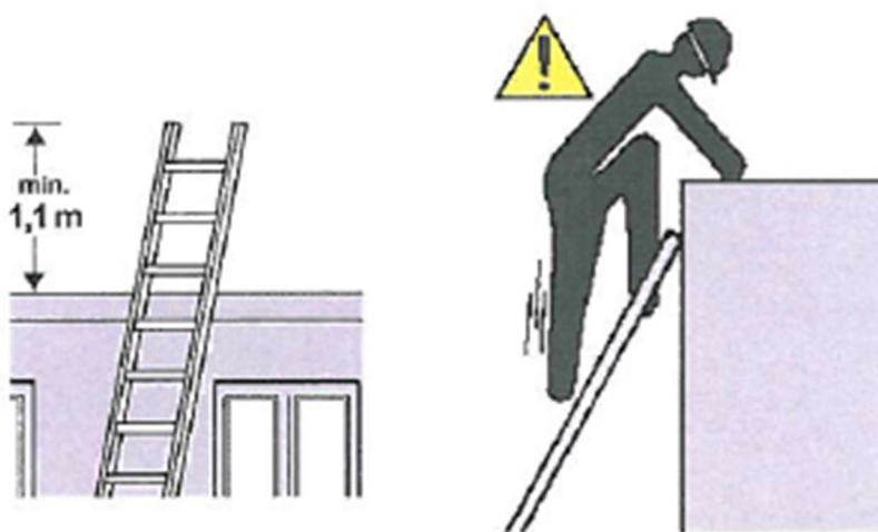
Obrázek 45 – Požadovaný přesah žebříku
