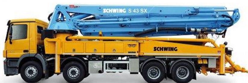
Obrázek 2: Čerpadlo betonové směsi SCHWING S 43 SX (6)
