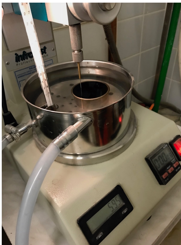
Obrázek 30 - Pohled na penetrometr při měření
