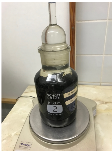
Obrázek 28 - Pyknometr se směsí bez vzduchových bublin
