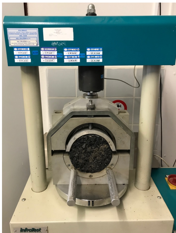
Obrázek 34 - Zkušební lis pro stanovení minimální smykové síly
