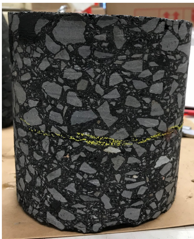
Obrázek 33 - Jádrový vývrt s vyznačením styčné plochy mezi zkoušenými vrstvami
