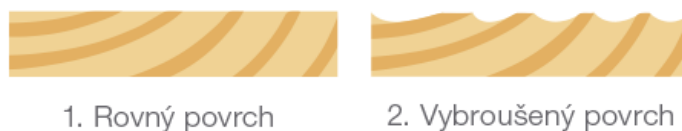
Obr. 40 Schéma povrchové úpravy trámů (zdroj 26 )
