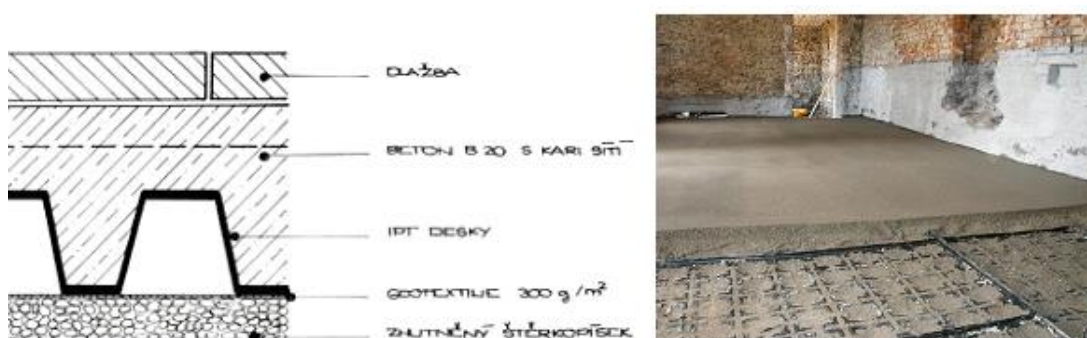
Obr. 32 Schéma a příklad provedení podlahy systémem IPT (zdroj 18 )
