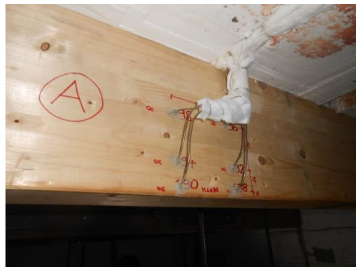
Obr. 18 Termočlánky v nosníku
