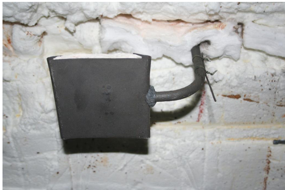
Obr. 14 Plášťový termočlánek a deskový snímač teploty 100 mm pod stropem
