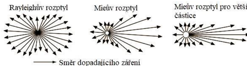
obr. 26: Rozptyl záření při použití Rayleighovy a Mieovy metody; [63]
