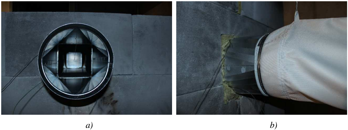
Obr. 57 Zkouška PZ3 – přechodový kus: a) průhled do potrubí uvnitř pece; b) upevnění textilu
