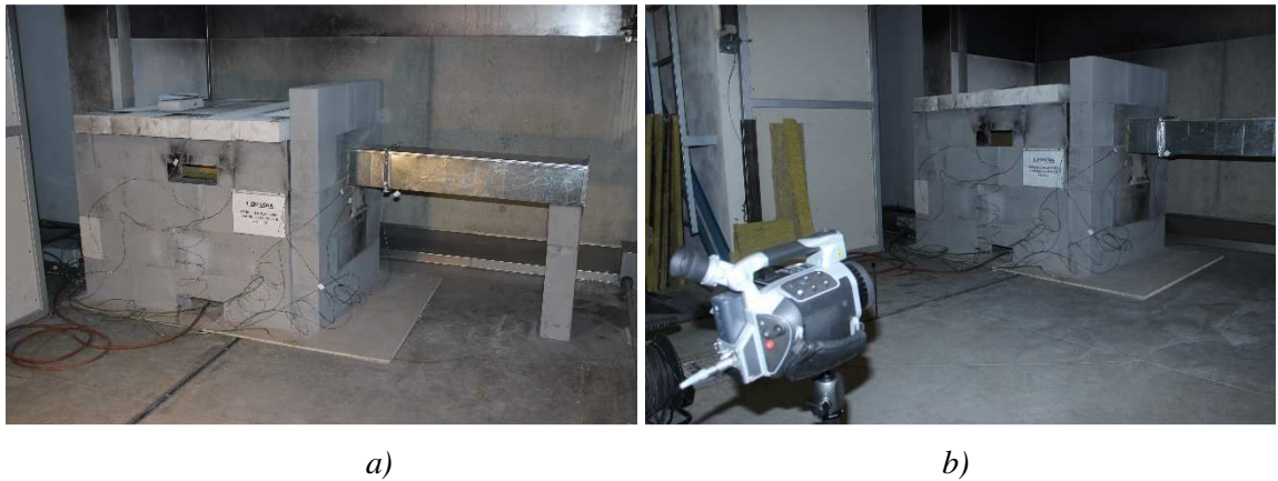
Obr. 49 Zkouška PZI – finální podoba zkoušky: a) potrubí prostupující vně pece; b) snímání potrubí termokamerou
