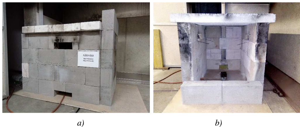
Obr. 44 Zkouška PZO – foto zkušební pece: a) vnější pohled; b) vnitřní pohled
