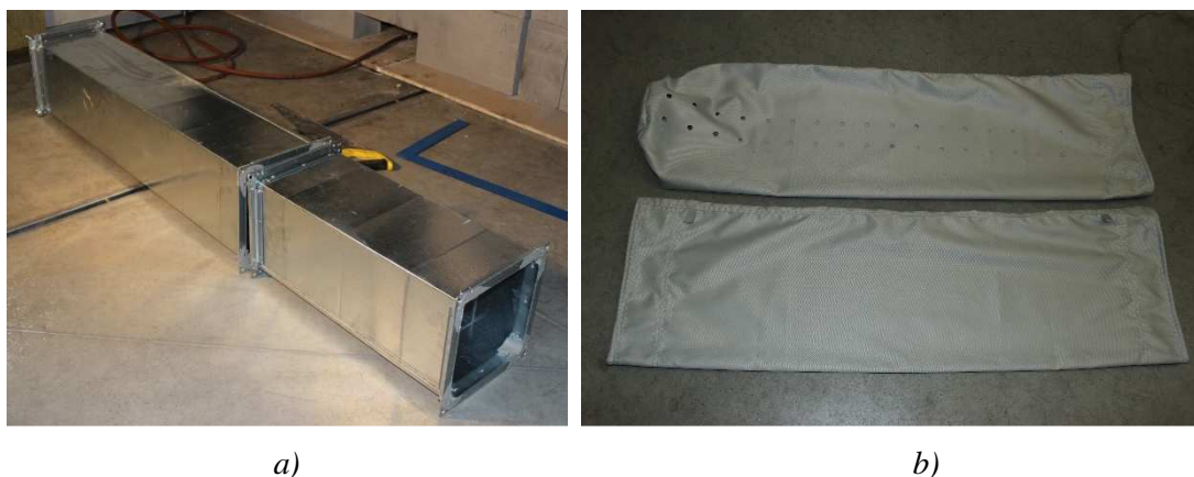
Obr. 43 Potrubí: a) pozinkované potrubí; b) textilní vyústka (nahore) a potrubí (dole)
