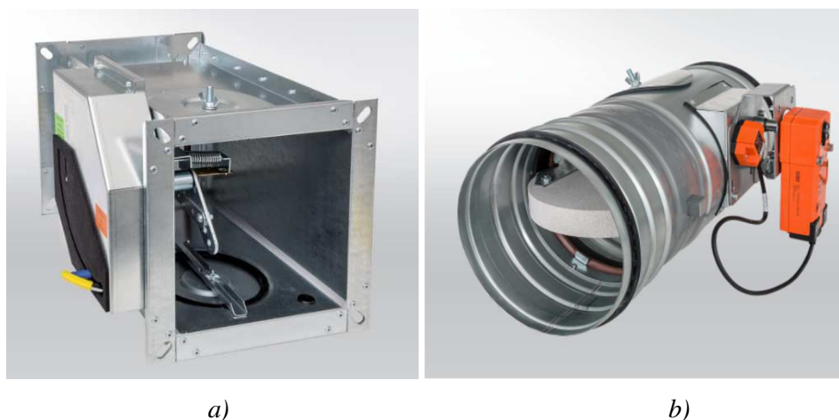
Obr. 17 Příklady požárních klapek (Mandík, a.s.) 11 : a) požární klapka ve čtyřhranném potrubí s tavnou pojistkou; b) požární klapka v kruhovém potrubí s elektromotorem
