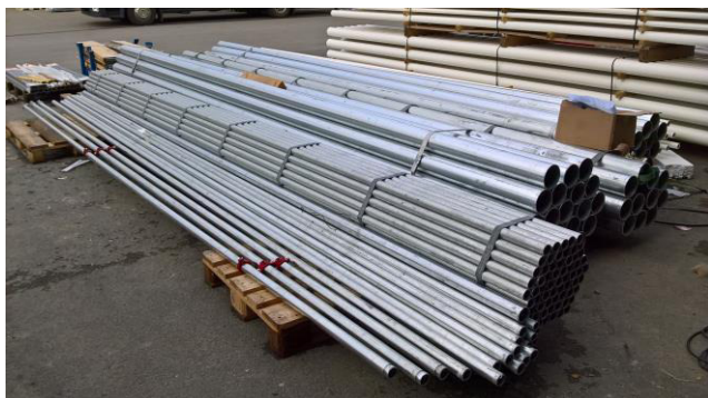
Obrázek 8 - Potrubí SHZ a) pozinkované potrubí pro suché rozvody; b) potrubí s bílým antikoročním nátěrem pro rozvody mokré soustavy
