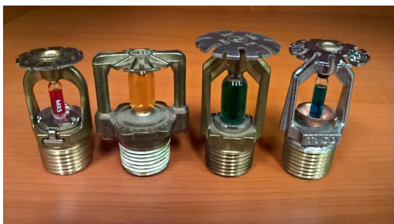
Obrázek 12 - Hlavice s různými otevíracími teplotami; zleva: červená 68 °C, žlutá 79 °C, zelená 93 °C a modrá 141 °C
