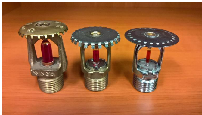
Obrázek 13 - Hlavice s různými tepelnými odezvami (a) rychlá tepelná odezva, průměr tepelné pojistky 3 mm; (b) standardní tepelná odezva, průměr tepelné pojistky 5 mm
