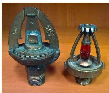
Obrázek 2 – Historické sprinklerové hlavice; vlevo hlavice s tavnou pojistkou firmy Walther&Cie Aktiengesellschaft z roku 1907; vpravo hlavice se skleněnou tepelnou pojistkou firmy Grinnell z roku 1949
