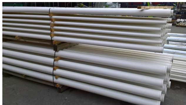
Obrázek 8 - Potrubí SHZ a) pozinkované potrubí pro suché rozvody; b) potrubí s bílým antikoročním nátěrem pro rozvody mokré soustavy
