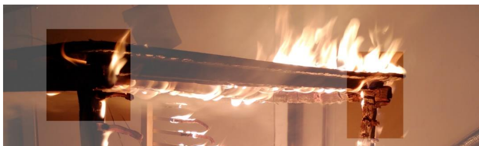
Obr. 28: Vyznačené místa, ve kterých došlo ke kolapsu
