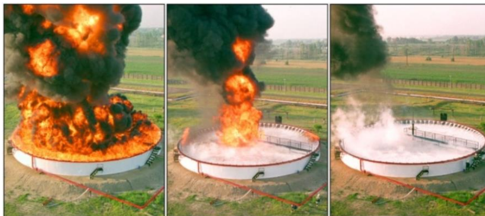
obr. 12: Hašení hořící nafty pomocí pěny [24]
