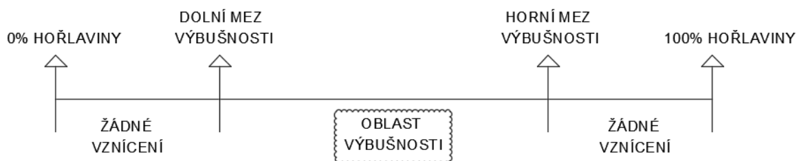
obr. 2: Schéma mezí výbušnosti
