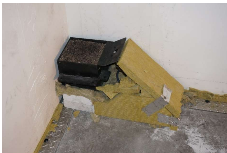
Propanový hořák zakrytý izolantem z minerální vaty.
