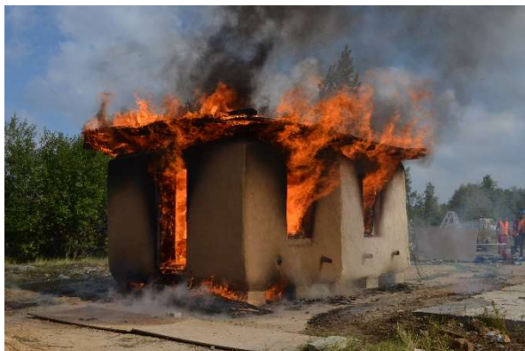
Obr. 35 Vyšlehávání plamenů okenními otvory
