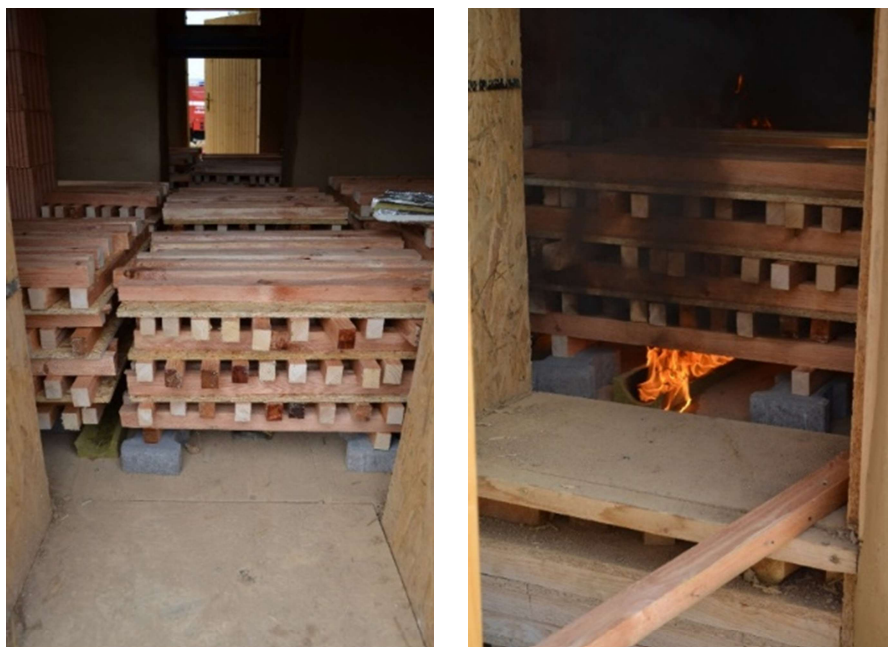
Obr. 17 Rozmístění a zapálení požárního zatížení (dřevěných hranic) uvnitř objektu
