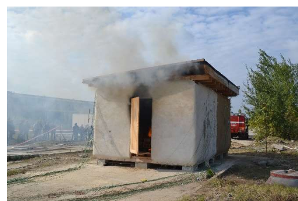
Obr. 32 Slaměný objekt po zapálení požárního zatížení (severo-východní pohled)
