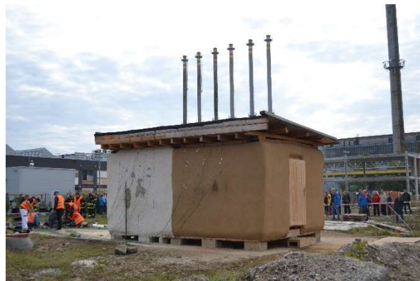
Obr. 30 Slaměný objekt před požární zkouškou (severo-západní pohled)
