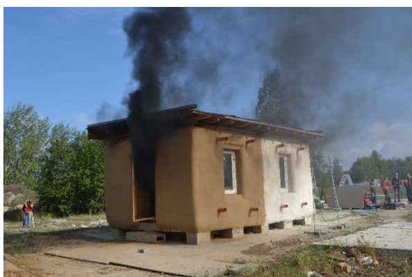
Obr. 31 Slaměný objekt po zapálení požárního zatížení (jiho-západní pohled)
