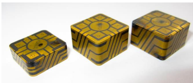
Obrázek 20 Břitová destička s nanesenou odporovou vrstvou [12]
