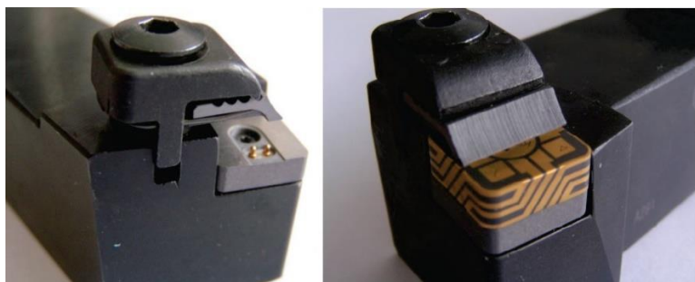
Obrázek 21 Nástrojový držák s kontakty - vlevo bez destičky, vpravo s destičkou [12]
