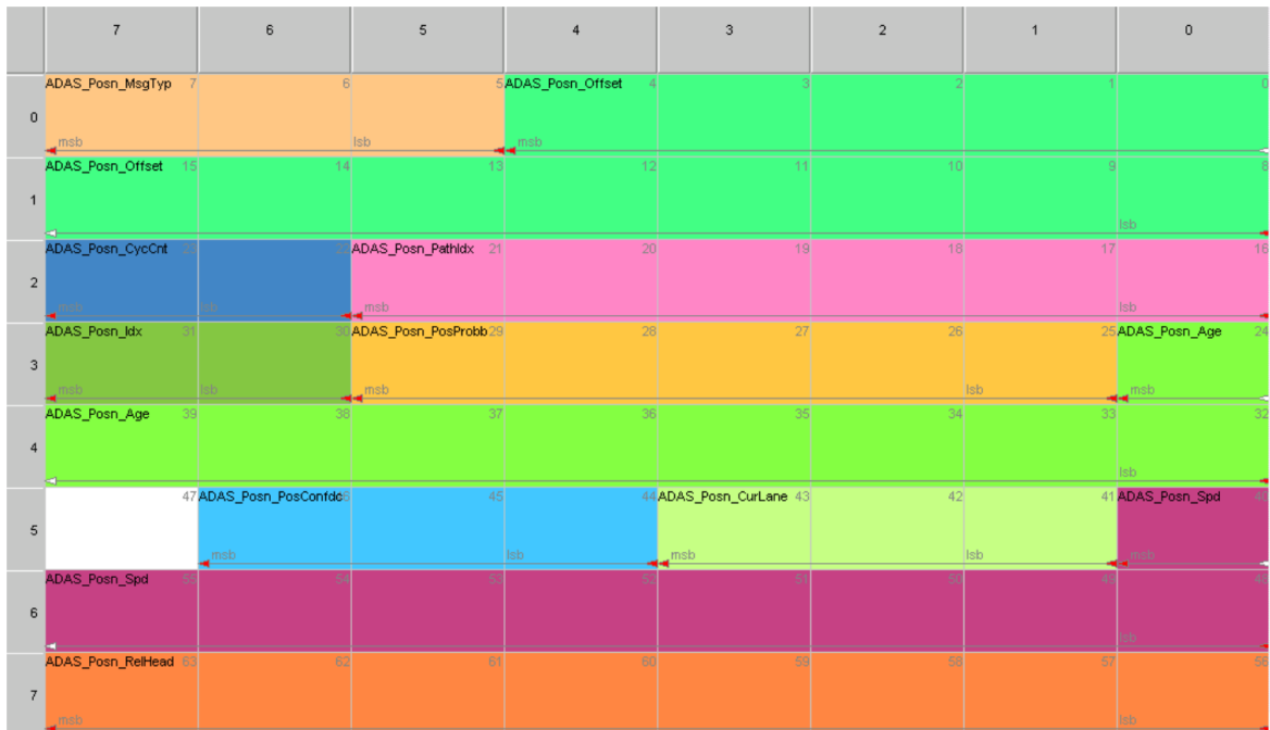
Obrázek 10: Bitové schéma ADASIS rámce typu pozice [2]
