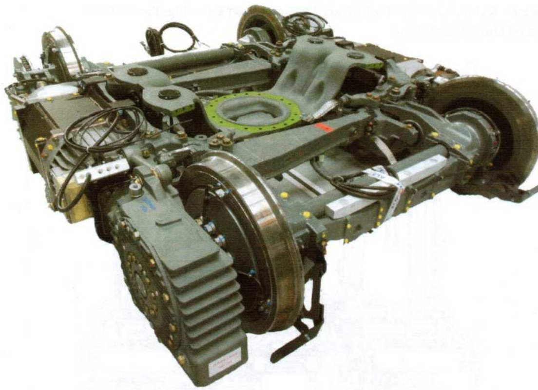
Obrázek 4 - Nový podvozek Citadis [1]
