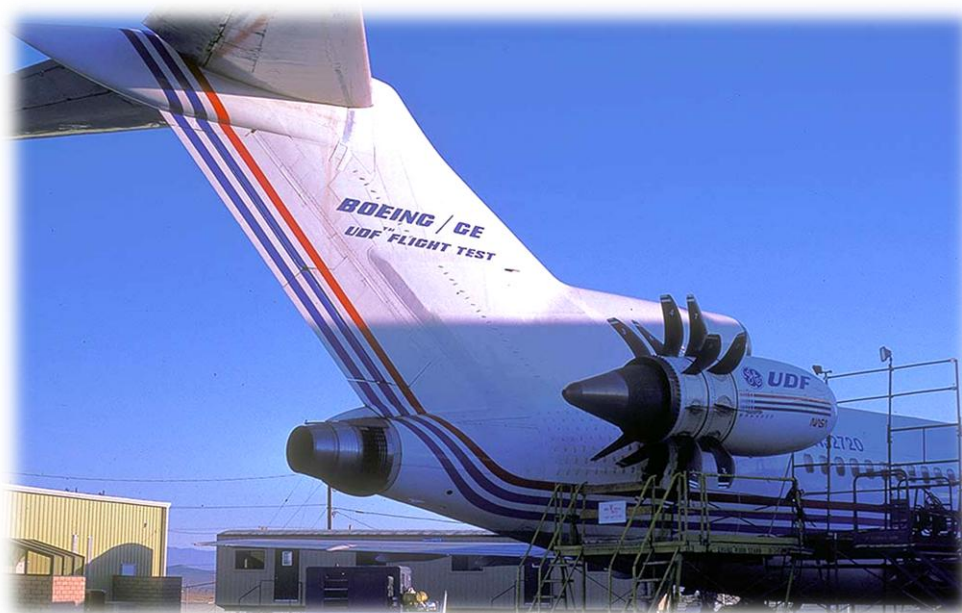
Obrázek 9: Zástavba motoru UDF (Zdroj: Air and Space [online]. [cit. 2016-06-07]. Dostupné z: http://www.air-and-space.com/Boeing_Testbeds.htm )
