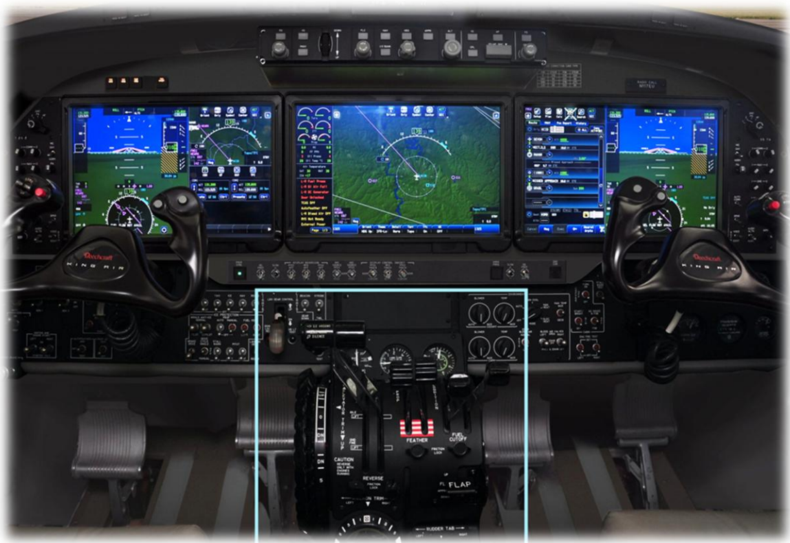
Obrázek 12: Ovládání pohonných jednotek (Upraveno z: Pro Line Fusion integrated avionics cockpit with touchscreen controls on King Air 350 turboprop. In: Avionics [online]. 2017 [cit. 2017-04-29]. Dostupné z: http://cdn.aviationtoday.com/wp-content/uploads/2013/10/Pro20Line20Fusion20King20Air2025028129.jpg )
