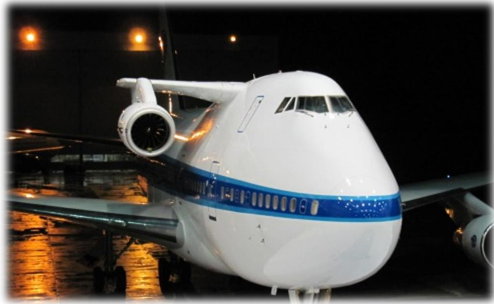
Obrázek 8: Přestavba Boeingu 747 SP (Zdroj: Aviation week network [online]. 2016 [cit. 2016-06-07]. Dostupné z: http://aviationweek.com/awin/pratt-whitney-starts-flight-tests-mrj-engine )
