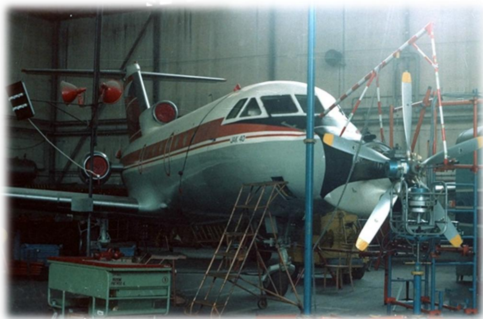
Obrázek 5: Jak-40 se zkušebním motorem M-601 (Zdroj: Aviation history [online]. 2016 [cit. 2016-06-07]. Dostupné z: http://aviahistory.ucoz.ru/index/0-312 )
