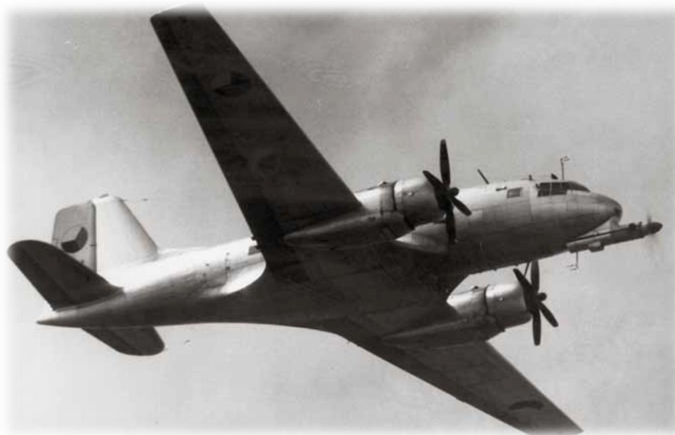
Obrázek 3: Av-14 se zastavěným motorem M-601 (Zdroj: VYMĚTAL, Ladislav a Jožka Špelina. 85 LET ve službách letectví 1922 — 2007: Letové zkoušky — Historie a současnost. Praha: Studio Winter s.r.o. Praha, 2007.)
