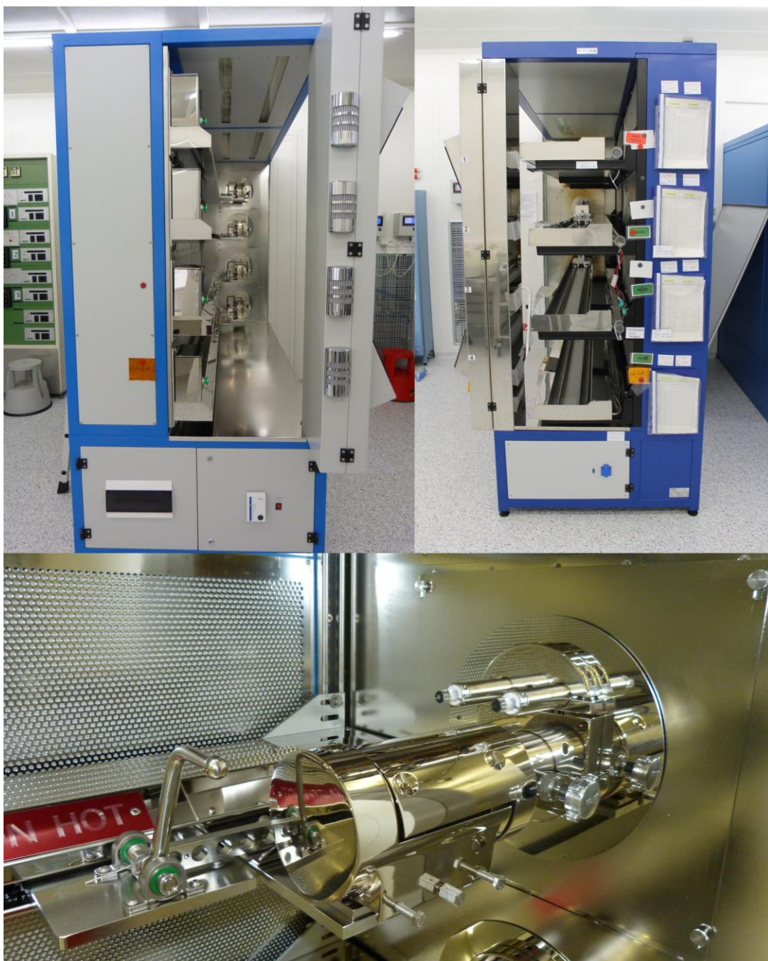
obr. 22 Zakladače MRL (vlevo), kolejové zakladače (vpravo) a detail hlavy zakladače MRL
