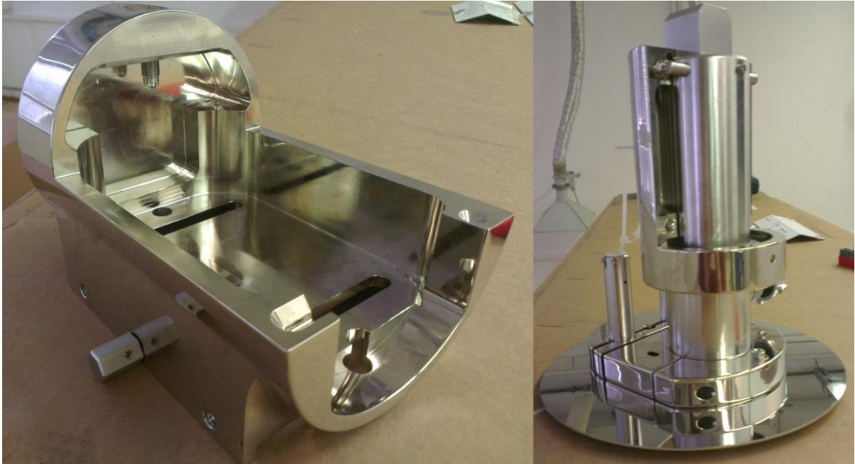
obr. 29 Spodní (vlevo) a horní (vpravo) část zakladače MRL
