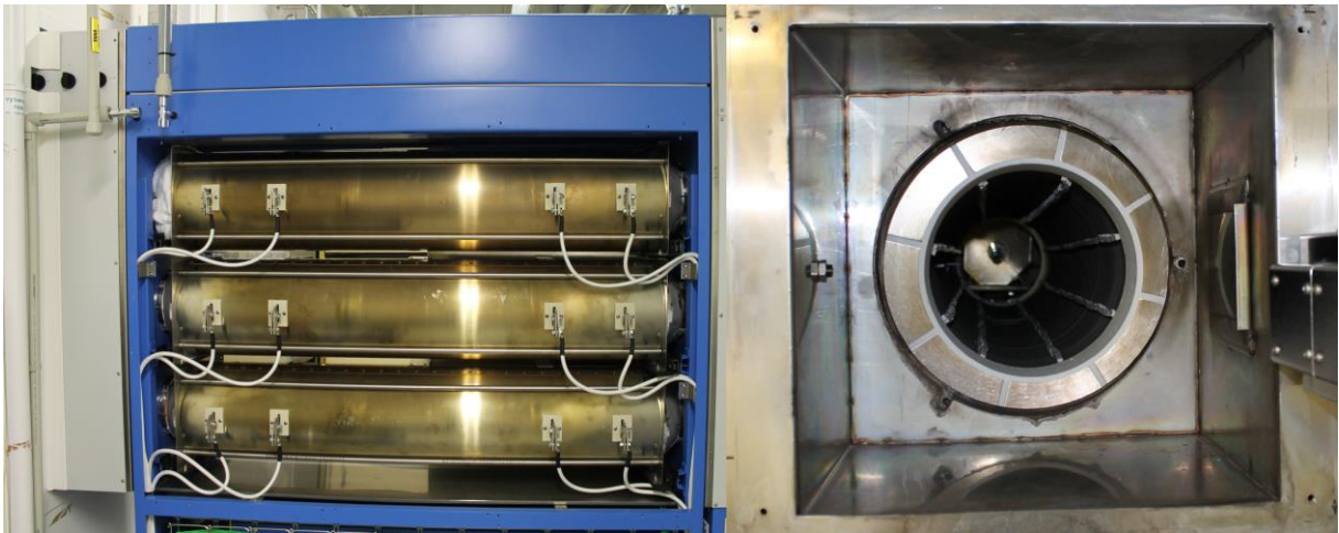
obr. 4 Trojice topných kazet v difuzní peci DA62 s pohledem do dutiny kazety z čistého prostoru
