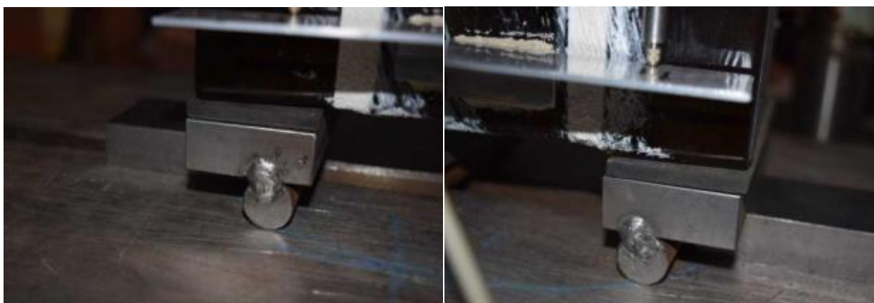
Obr. 4.7 Uložení vzorku přes gumové podložky
