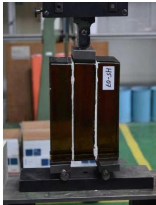
Obr. 4.6 Uložení vzorku ve zkušebním stroji
