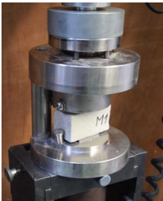
Obr. 4.20 Přípravek na zkoušku v tlaku s osazeným trámečkem
