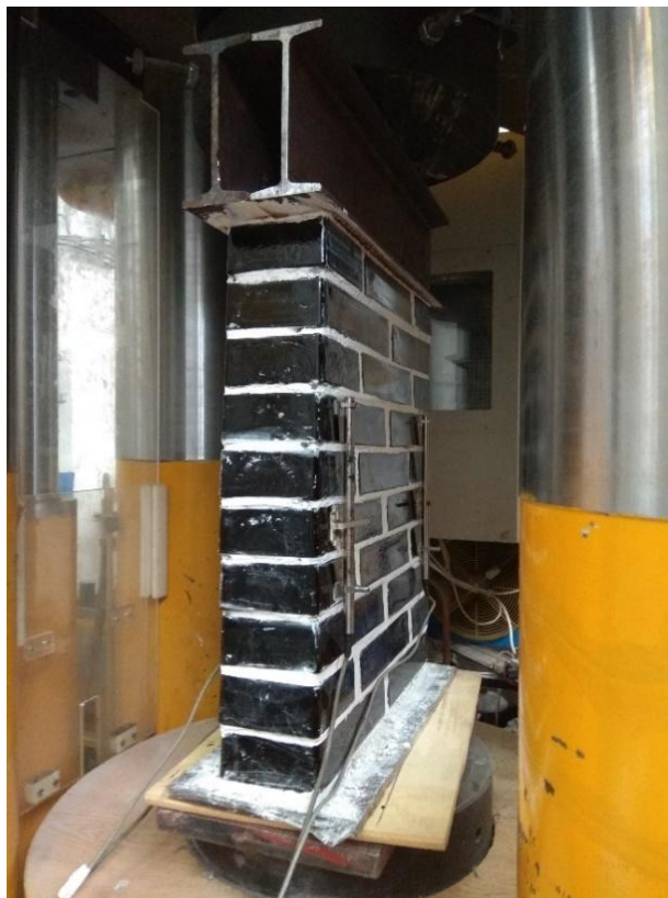
Obr. 4.23 Těleso v zařízení s přilepenými I profily na horní hraně
