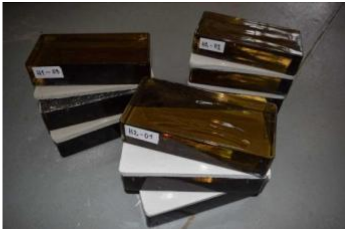
Obr. 4.8 Tělesa rozpadlá před zkouškou
