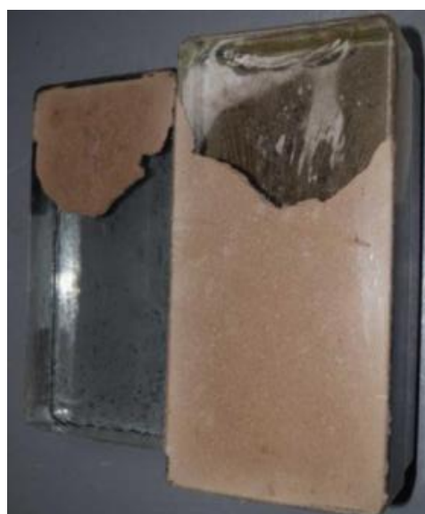
Obr. 4.10 Zkušební tělesa s adhezním porušením
