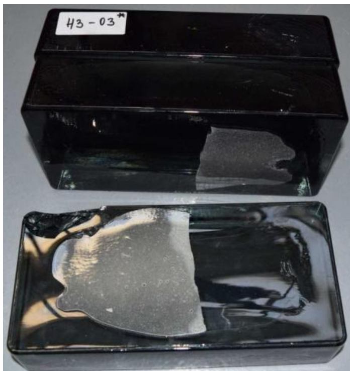
Obr. 4.9 Kombinované porušení tělesa s epoxidovou pryskyřicí
