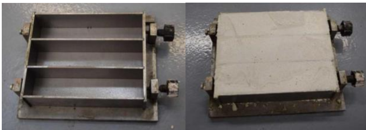
Obr. 4.15 Trojforma na trámečky pro zkoušení malt
