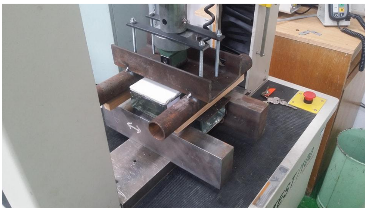
Obr. 4.14 Zkoušené těleso v zařízení MTS Elite Q100
