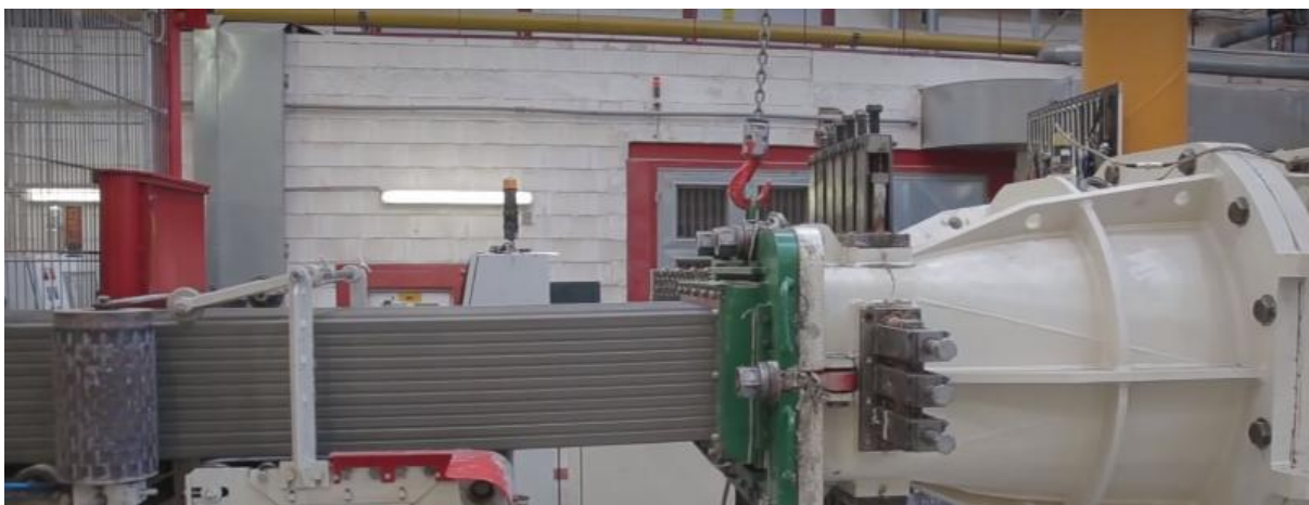
Obr. 2.13 3 Výroba cihel tažením
