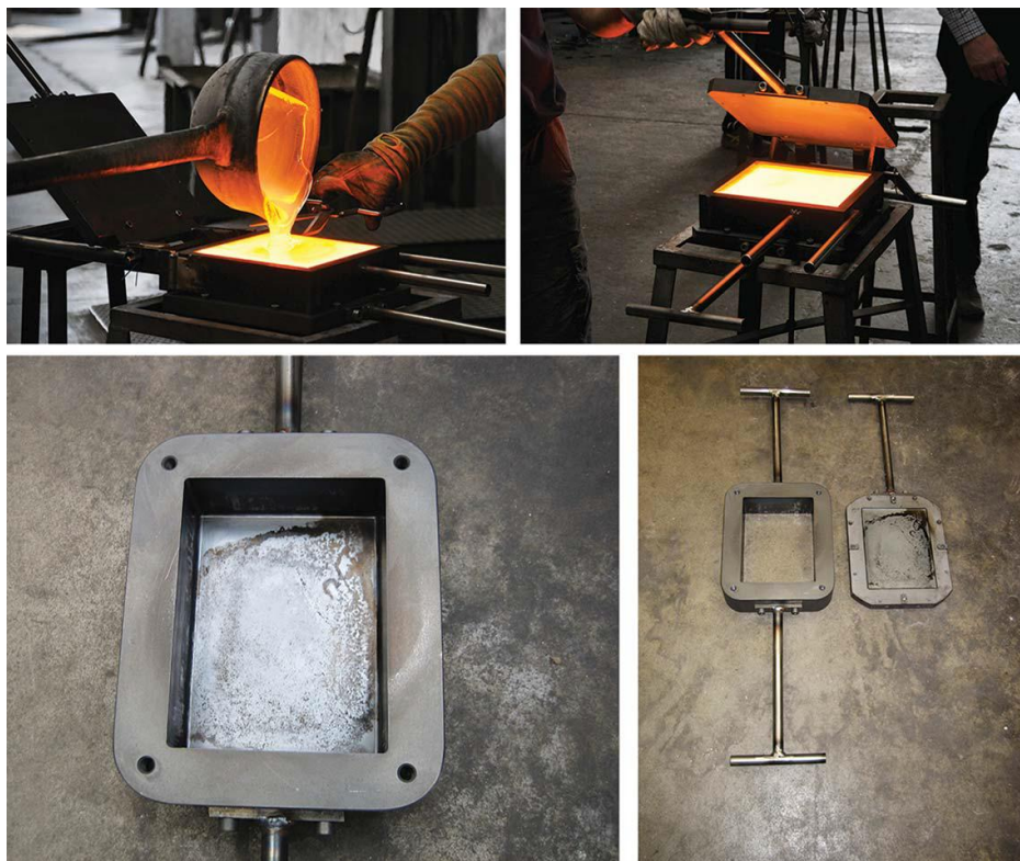
Obr. 3.6 Ruční odlévání skleněných cihel
