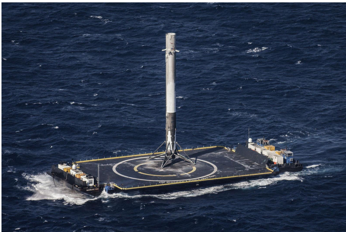
Obrázek 4: První stupeň rakety Falcon 9, po přistání na ASDS [28]
