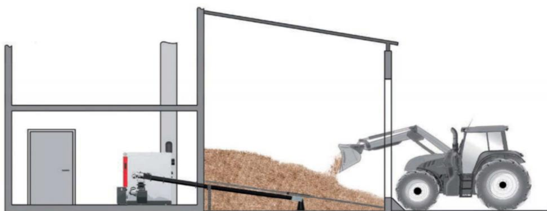
Obr. 9 - Schéma kotelny, podavače štěpky a skladu na štěpku [41]
