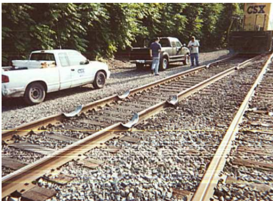
Obr. 19 Příklad následků dlouhotrvajícího skluzu hnacího vozidla
