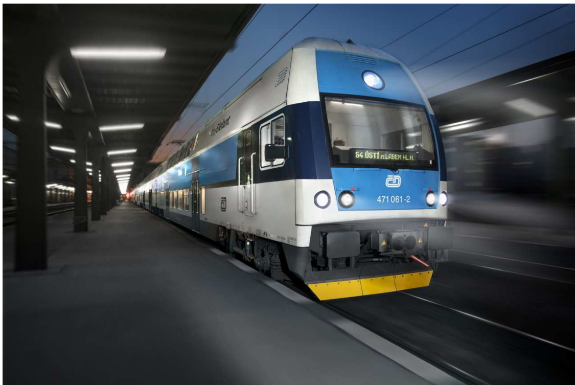
Obr. 2 Elektrická jednosystémová (3 kV ss) jednotka ČD řady 471
