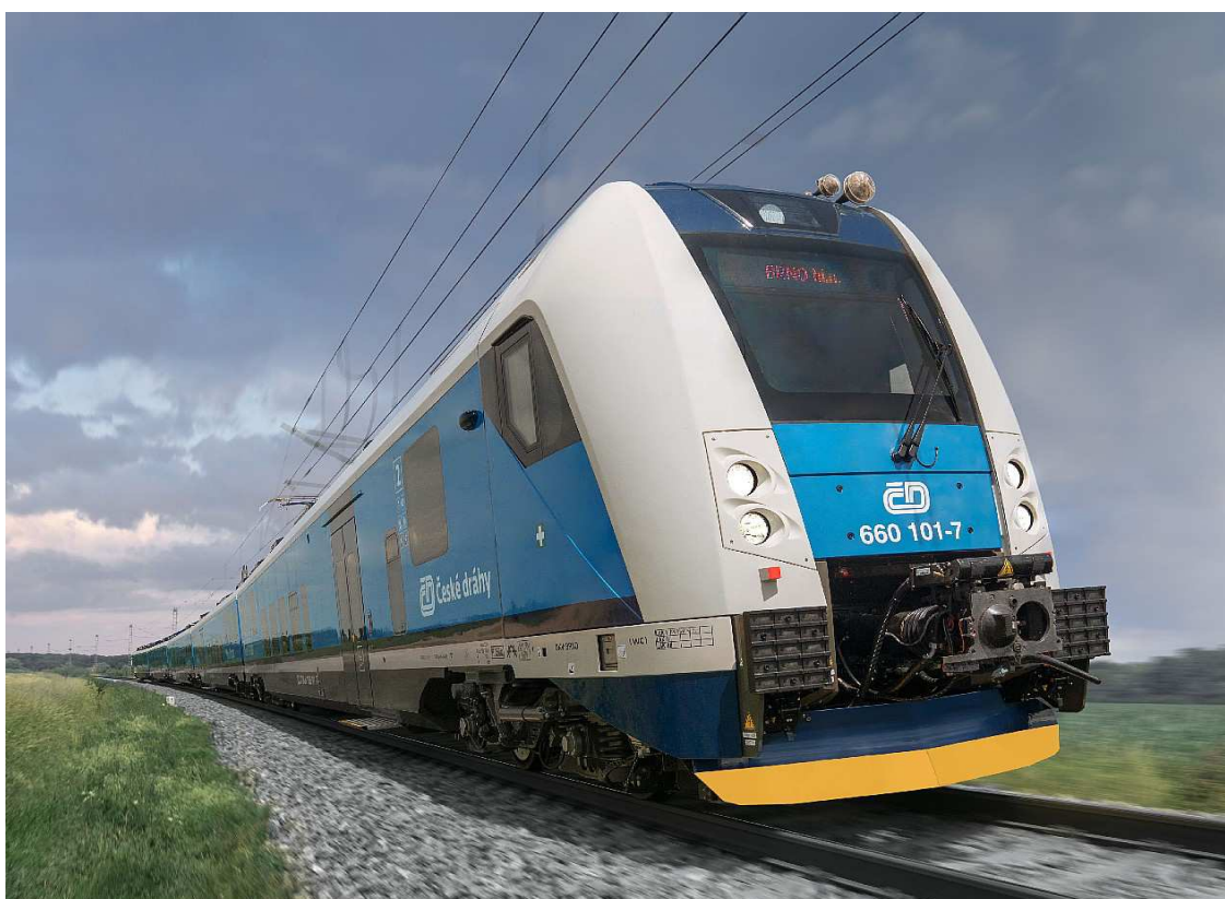
Obr. 3 Elektrická dvousystémová jednotka ČD řady 660
